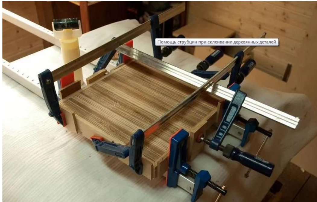
Допомога струбцин при склеюванні дерев'яних деталей
