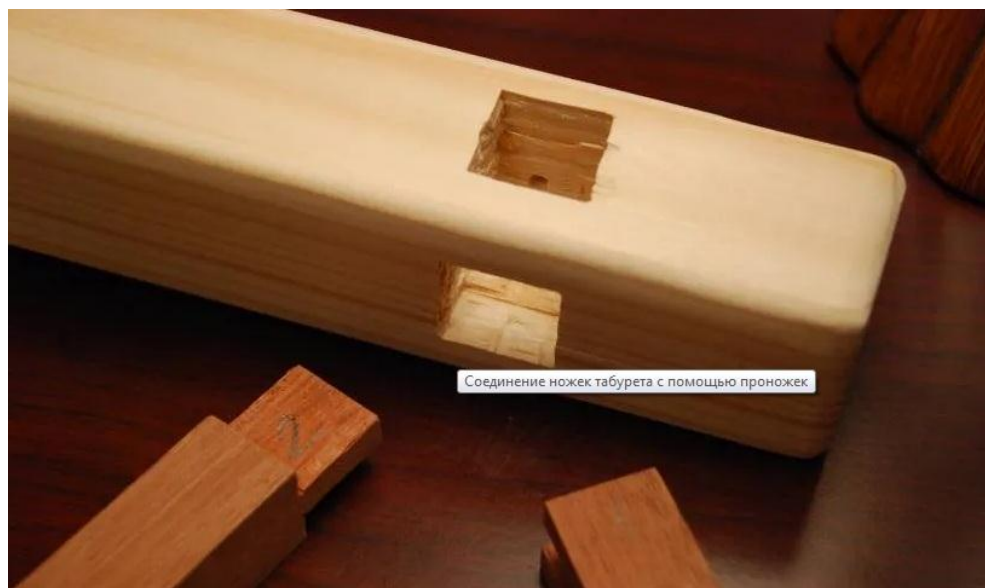
З'єднання ніжок табурету за допомогою проніжок
