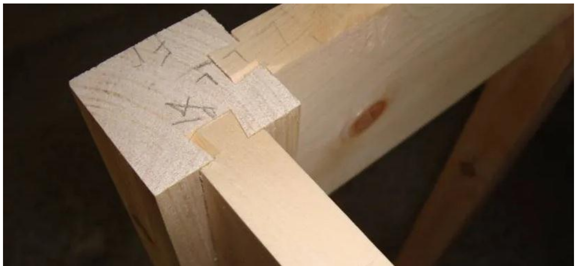
Царга на табуреті, закріплена в ластівчин хвіст.
