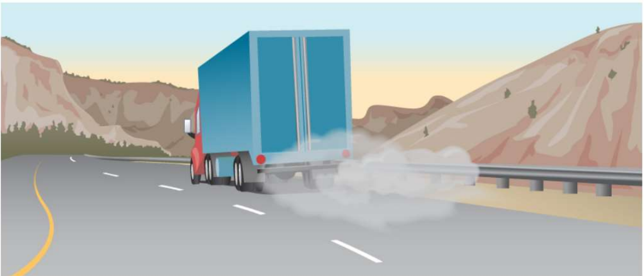
Рис. 1.11. Димлячі гальма на гальмівній вантажівці є видимим доказом механічного еквівалента тепла
