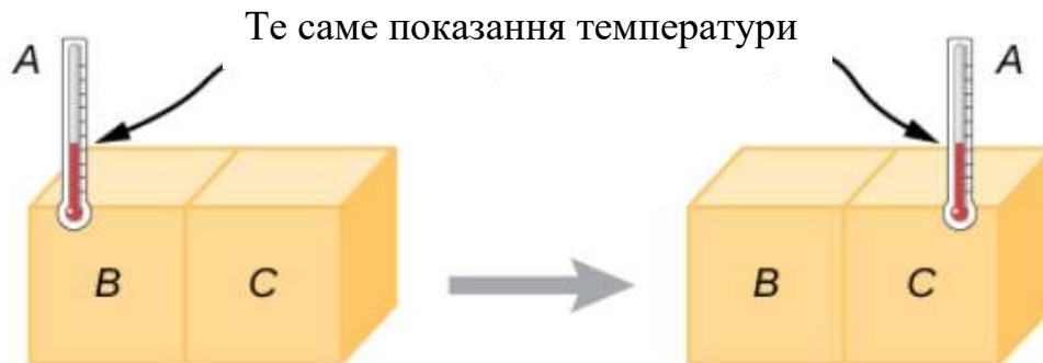
Рис. 1.2. Якщо термометр A перебуває в тепловій рівновазі з об'єктом B , а B перебуває в тепловій рівновазі з об'єктом C , тоді A перебуває в тепловій рівновазі з об'єктом C . Тому показання на A залишаються незмінними, коли A переміщується, щоб увійти в контакт з C
