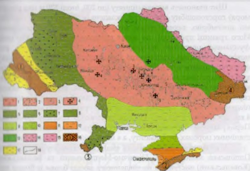
Рис. 4. Схема районування осадового чохла території України (складена з використанням матеріалів Л. С. Галецького та ін.)
