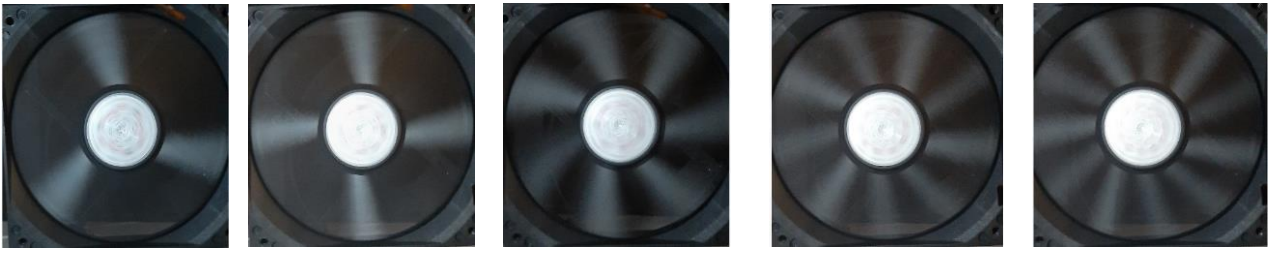
Рис. 2. Лопать вентилятора при освітлення стробоскопом з різними частотами
