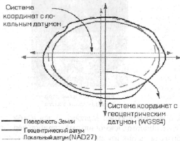
Рис. 4. Соотношение геодезических датумов и поверхности Земли
