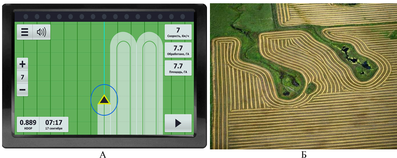
Рис. 2.6. Зображення на екрані навігатора (курсказівника) трактора в режимі паралельного водіння (А) і супутниковий знімок поля, зораного в цьому режимі (Б)
