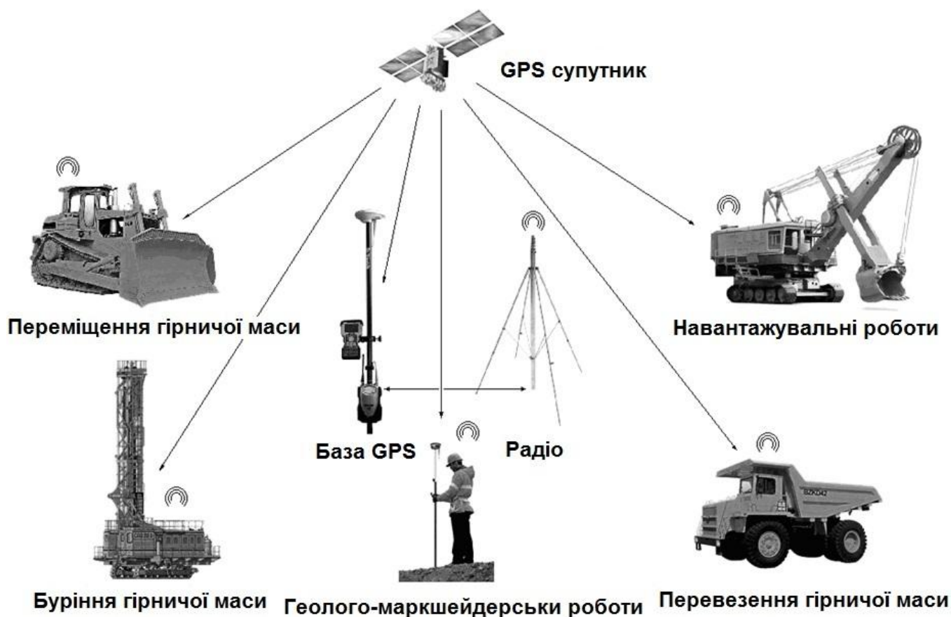
Рис. 2.4. Система організації управління виймально-навантажувальною технікою та буровим обладнанням на гірничому підприємстві з використанням системи супутникового позиціонування
