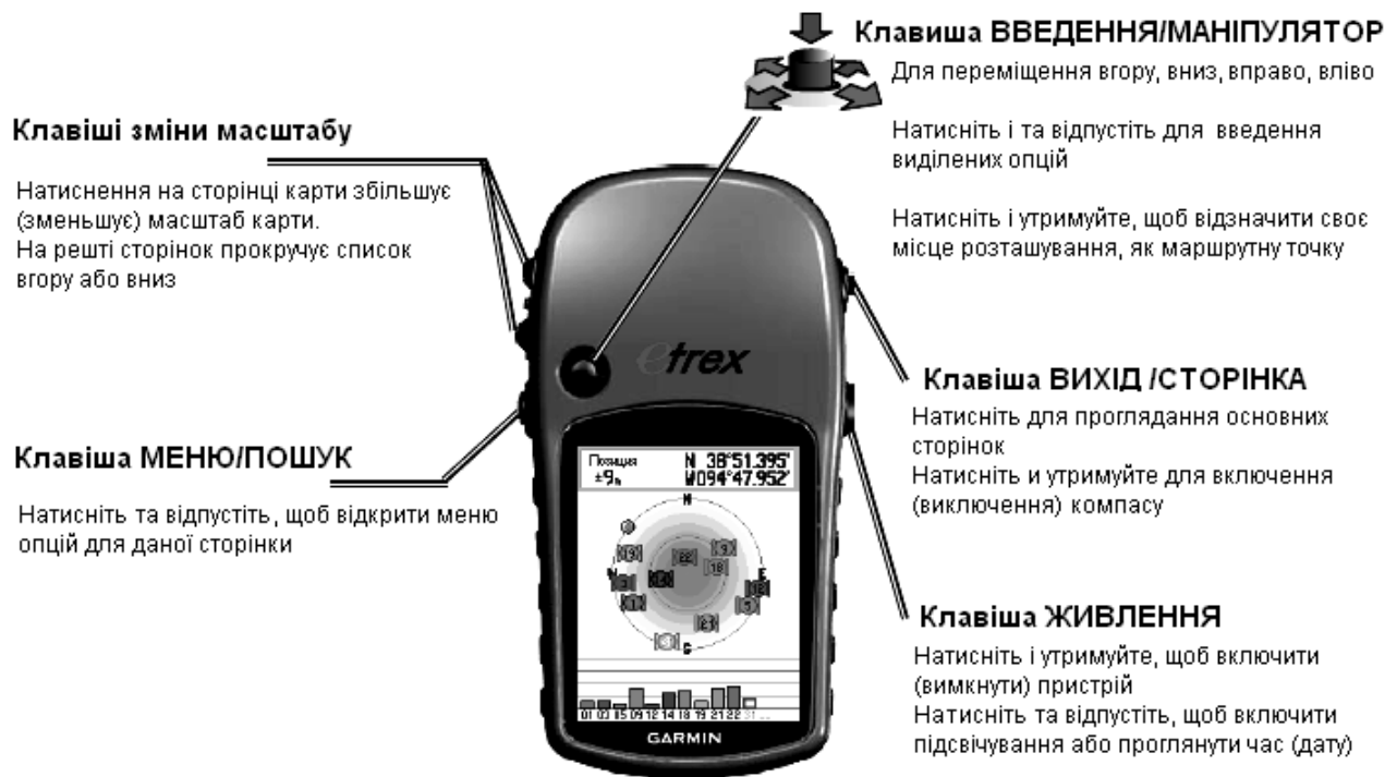
Рис. Д-1. Функціональне призначення клавіш управління навігатора
