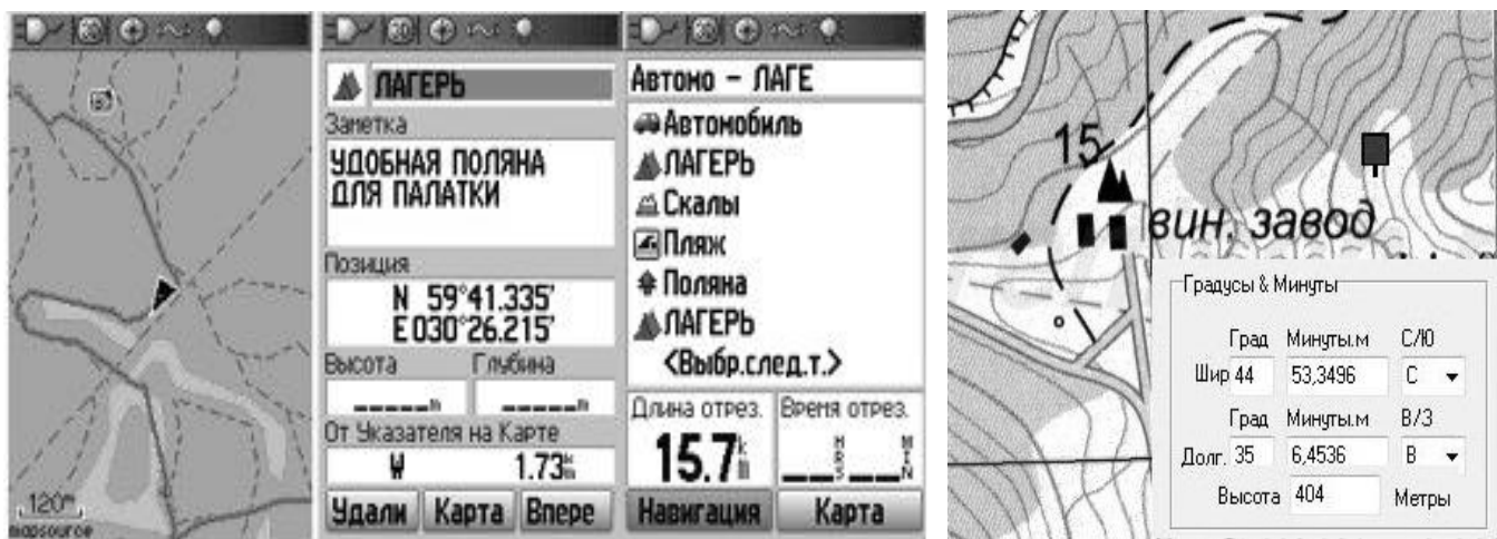
Рис. 1.16. Екран навігатора з відображенням шляхової точки і її характеристикою (ліворуч), а також фрагмент топографічної карти околиці Сонячної долини (Крим, Україна) з відображенням координат гроту на південному схилі гори Панджарлар-Кая (праворуч)
