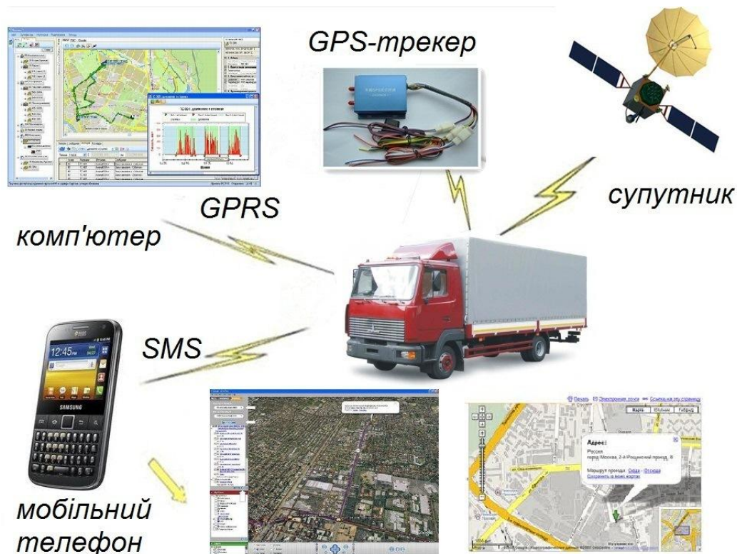
Рис. 2.3. Структура GPS -системи спостереження за транспортом
