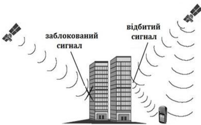
Рис. 1.8. Відображення та блокування супутникових сигналів
