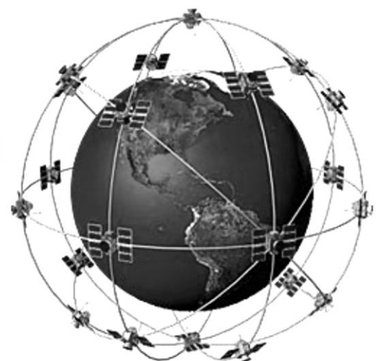
Рис. 1.11. Космічний сегмент системи GPS
