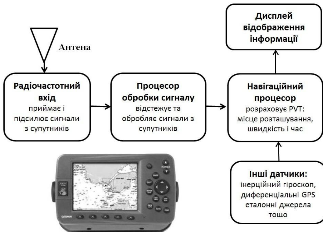
Рис. 1.12. Принципова блок-схема будови супутникового навігатора
