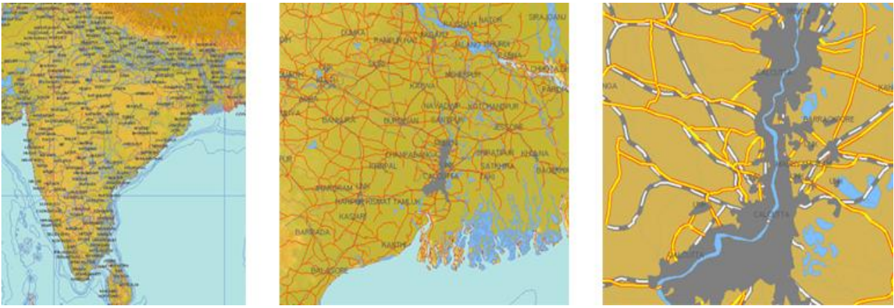
Рис. 3.32. Генералізація зображення в ГІС при зміні масштабу картографічного зображення: ліворуч M = 1: 10000000 ; в центрі M = 1: 1000000 ; праворуч M = 1: 100000 .
