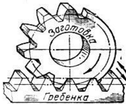
Рис. 2. 5. Нарізання зубців інструментальною рейкою-гребінкою
