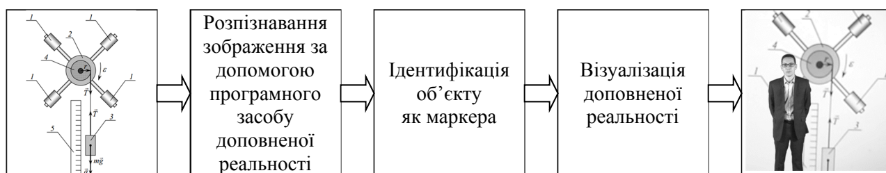
Рис. 1.16. Схема реалізації доповненої реальності (за Ю. В. Єчкало та ін. [51])
