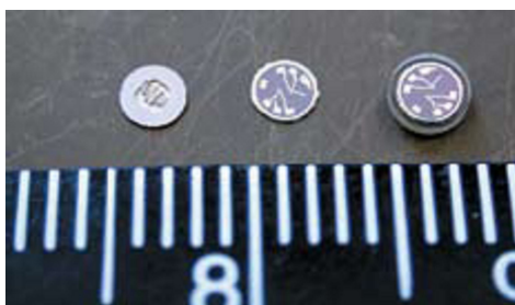
Рис. 4. Структура чутливого елемента датчика відносного тиску ДВТ-116: 1 – мембрана; 2 – потовщена периферійна частина; 3 – концентратори механічних напруг; 4 – тензорезистори
