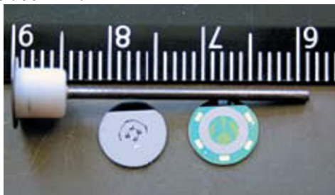
Рис. 3. Чутливий елемент датчика відносного тиску ДВТ-060
