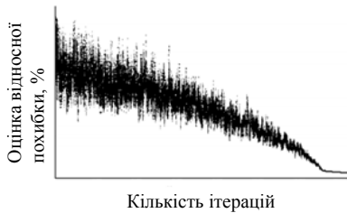
Рис. 1. Поведінка цільової функції алгоритму імітації відпалювання [4]
