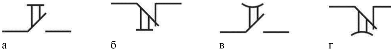
Рис. 18.6. Види контактів у системах автоматики: а – контакт, який замикається, з витримкою на замиканні; б – контакт, що розмикається, з витримкою на розмиканні; в – контакт, що замикається, з витримкою на розмиканні; г – контакт, що розмикається, з витримкою на замиканні
