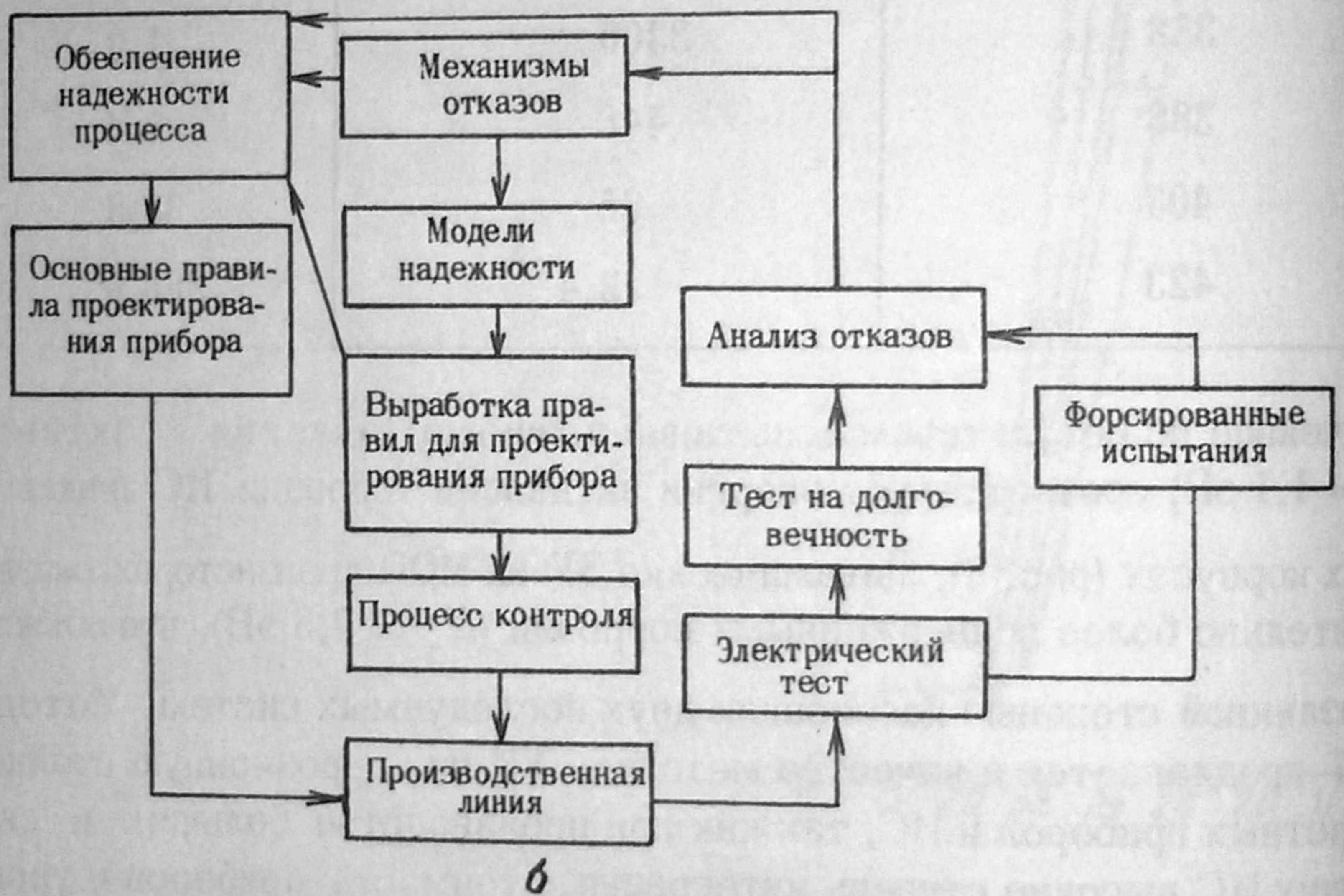
Рис. 7. Стандартная (а) и современная (б) схемы исследования полупроводниковых приборов на надежность
