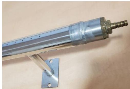
Рис. 3.8. Кінець трубки, з'єднаний із джерелом газу
