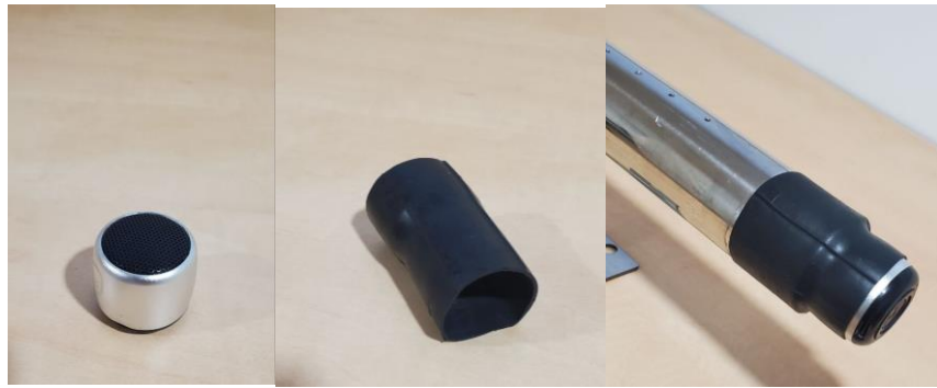
Рис. 3.9. Кінець трубки, з'єднаний Bluetooth-колонкою
