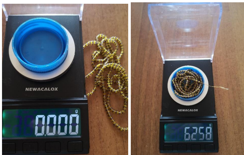
Рис. 3. 5. Вимірювання маси мотузки №2 на електронних терезах
