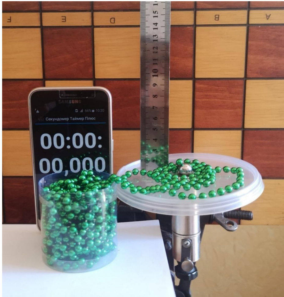
Рис. 3. 4. Фото експериментальної установки: 1 – пускова установка, 2 – пусковий курок, 3 – кулька, 4 – ланцюг, 5 – лінійка, 6 – секундомір
