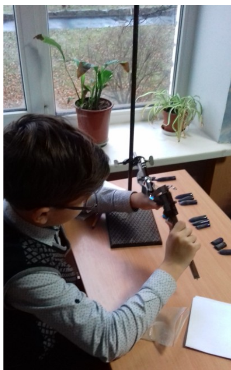
Рис. 2.10. Вимірювання розмірів блоків кристалосировини електронним штангенциркулем.
