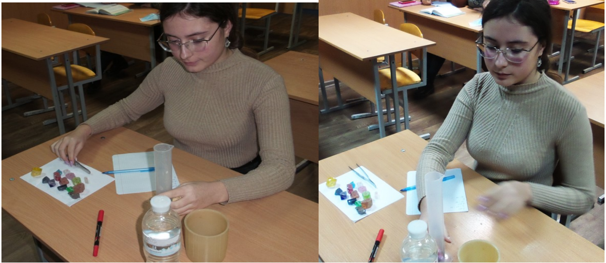
Рис. 2.12. Вимірювання об'єму води, витиснутої блоком фіаніту.
