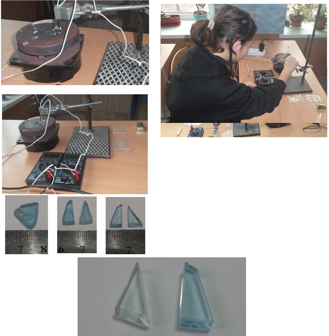
Рис. 2.4. Експеримент з визначення температурного діапазону, коли многогранник з топазу змінює свій колір.
