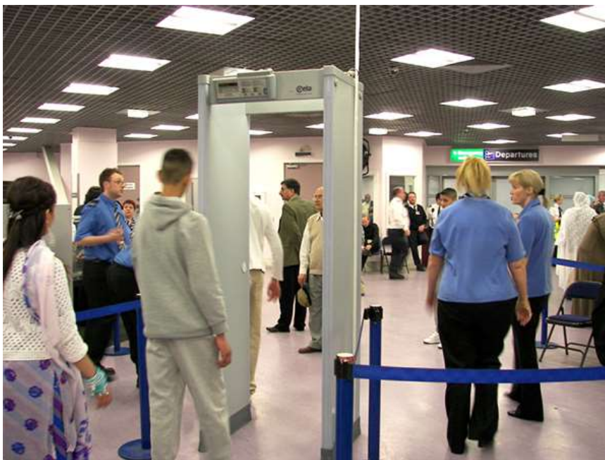
Рис. 4.9. Звичайний гейт безпеки в аеропорту не тільки виявляє метали, але і може вказувати на їх приблизну висоту над підлогою
