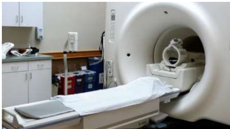
Рис. 2.21. У апараті МРТ циліндричний соленоїд, що оточує пацієнта, генерує велике магнітне поле
