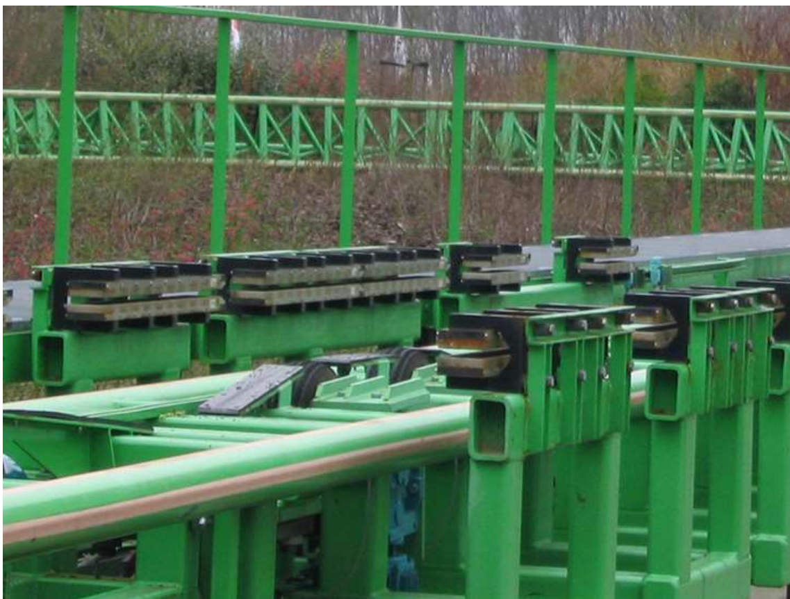
Рис. 3.26. Ряди рідкоземельних магнітів (виступаючих горизонтально) використовуються для магнітного гальмування в американських гірках
