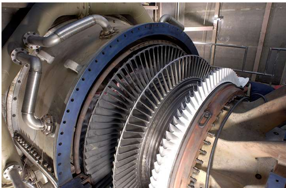
Рис. 3.31. Парова турбіна/генератор. Пара, що утворюється при спалюванні вугілля, діє на лопаті турбіни, повертаючи вал, який з'єднаний з генератором
