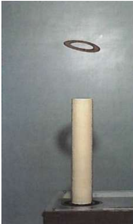
Рис. 3.10. Стрибуче кільце. При включенні струму у вертикальному соленоїді в металевому кільці індукується струм. Змінне поле, створюване соленоїдом, змушує кільце зіскакувати з соленоїда
