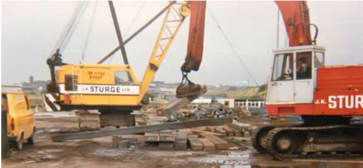
Рис. 1.1. Промисловий електромагніт здатний підняти тисячі кілограмів металевих відходів
