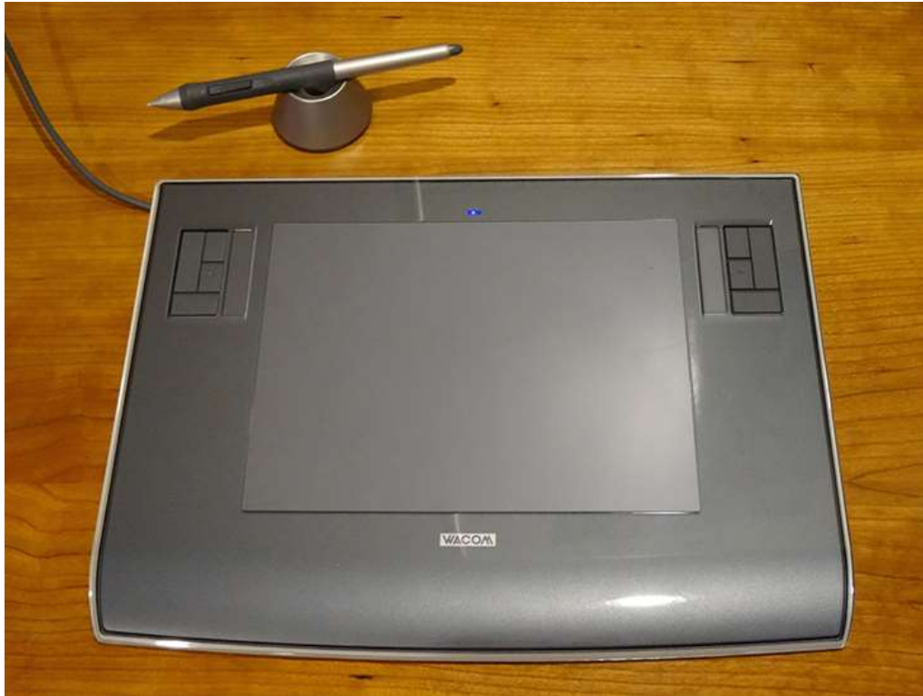
Рис. 3.34. Планшет зі спеціально розробленим пером для письма є ще одним застосуванням магнітної індукції
