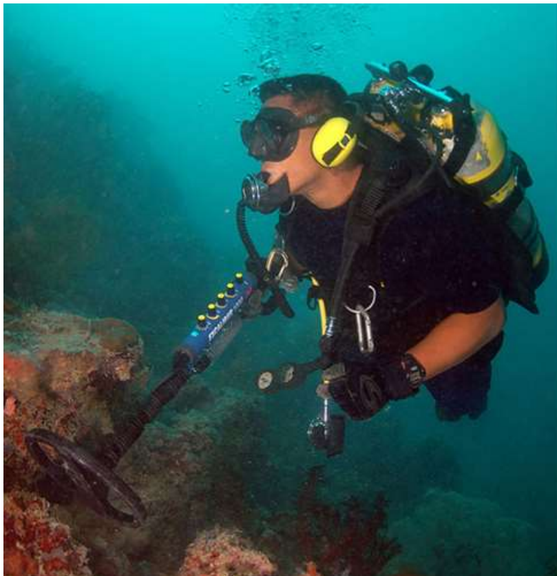
Рис. 5.19. Коли металощукач наближається до шматка металу, змінюється індуктивність однієї з його котушок. Це викликає зсув резонансної частоти контуру, що містить котушку. Цей зсув фіксується схемою і передається водолазу за допомогою навушників
