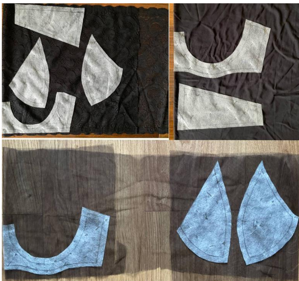
Рис. Б. 2.43. Розкрій деталей бюстгальтера
