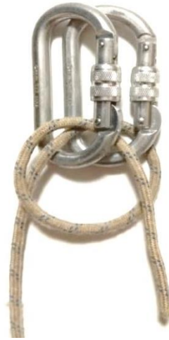
Рис. 6. Прикладаємо кільце лише до лівого карабіну. Взівши обидва краї мотузки, затягуємо вузол.
