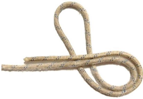
Рис. 3. Утворену подвійну мотузку вигинаємо в кільце, вигинаємо по годинниковій стрілці, утворюючи перше кільце вісімки. Ходова петля проходить під корінними кінцями.
