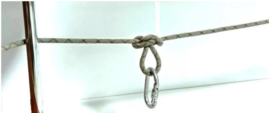
Рис. 1. На певній відстані від опори в'яжемо вузол серединний провідник (напівсхоплюючий, стремено) і прикріплюємо до вузла карабін (можна з блокроліком).
