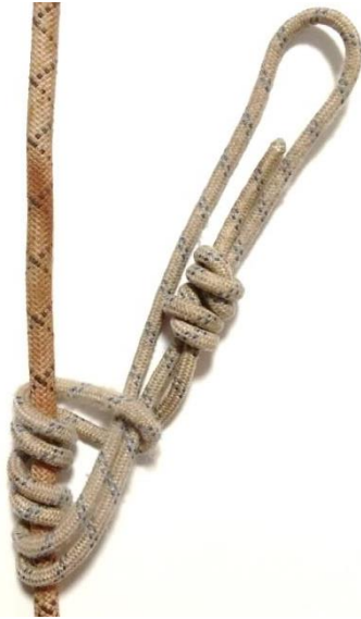
Рис. 9. Пропускаємо всю залишену частину тоншої мотузки в петлю. Затягуємо весь вузол.
