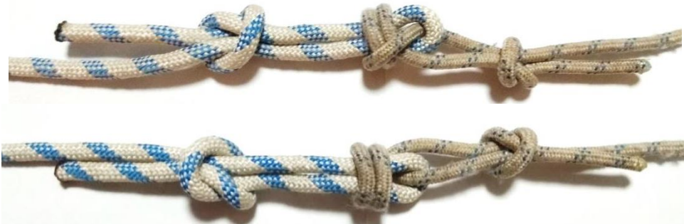
Рис. 20. Ненавантажені кінці виходять з однієї сторони вузла або з різних
