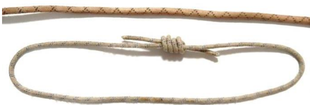
Рис. 1. Схоплюючий вузол в'яжеться тоншою мотузкою навколо товщої. Різниця між діаметрами мотузок, повинна бути, як мінімум 4 мм.
