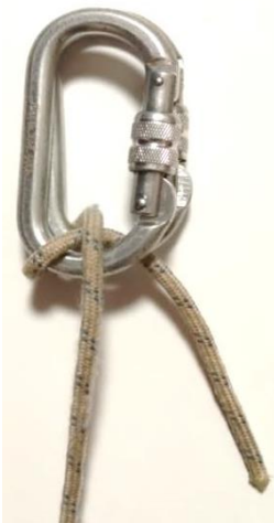
Рис. 7. Застосовується для страхівки або для створення додаткового гальмівного зусилля при натягуванні перил. Карабіни повинні мати однакову форму і розміщуватись в одну сторону.
