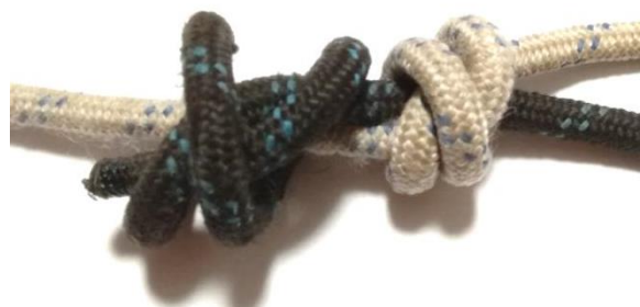
Рис. 14. Ходовий кінець темної мотузки повинен обов'язково проходити під двома обертами і поступово затягуємо вузол.
