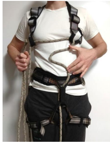
Рис. 6. Формуємо вигин з середньої частини мотузки.
