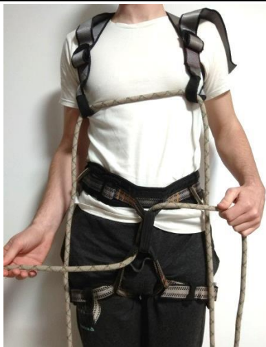
Рис. 3. Інший кінець мотузки, з гори до низу, пропускаємо через коуші нижньої системи.
