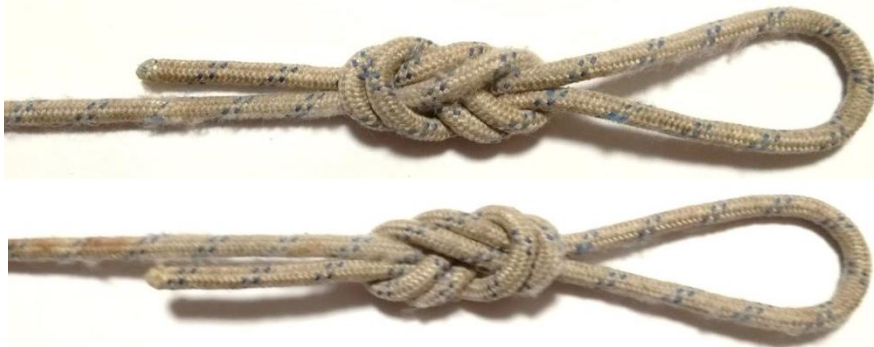
Рис. 6. Вузол затягуємо. Петля, утворена вантажним кінцем повинна знаходитися над петлею не навантаженого кінця. Відстань від вузла до крайньої точки петлі не повинна перевищувати 20 см.
