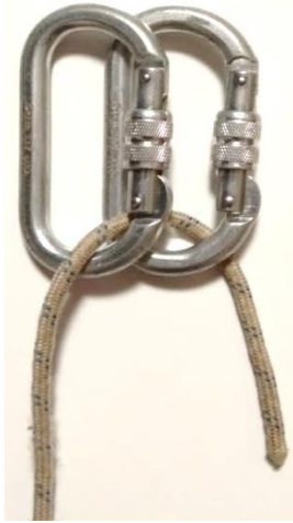
Рис. 3. Прикладаємо мотузку до обох карабінів одночасно.
