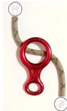
Рис. 2. З низу, до великого кільця «вісімки», прикладаємо мотузку, так, щоб мотузка, яка йде до опори, розміщувалася з ліва, а яка йде в низ – справа.
