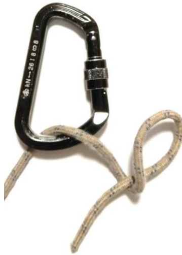
Рис. 5. Сформоване кільце, згинаємо на 90 градусів, в місці перехрещення мотузок.
