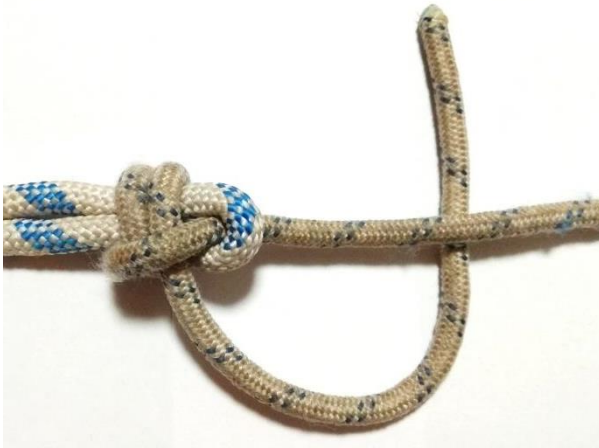
Рис. 13. Початок зав'язування контрольного вузла на тоншій мотузці. Згинаємо ходовий кінець тонкої мотузки і проводимо його під корінним кінцем.
