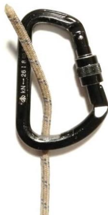
Рис. 2. Пропускаємо ходовий кінець мотузки в карабін з під низу. Муфта карабіна з права.
