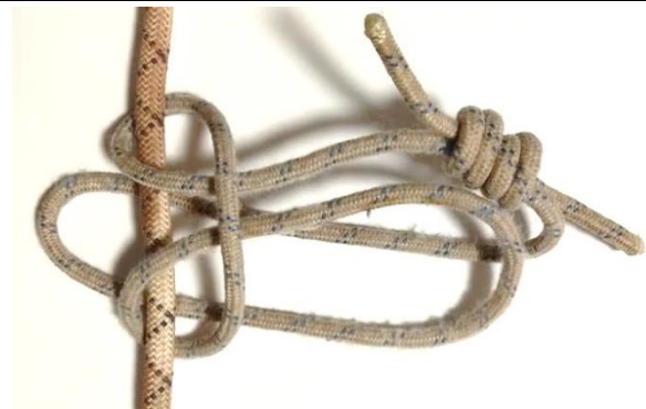
Рис. 6. Продовжуємо робити ще один оберт тоншою мотузкою навколо товщої. Оберт робимо в тому ж самому напрямку, що й перший.
