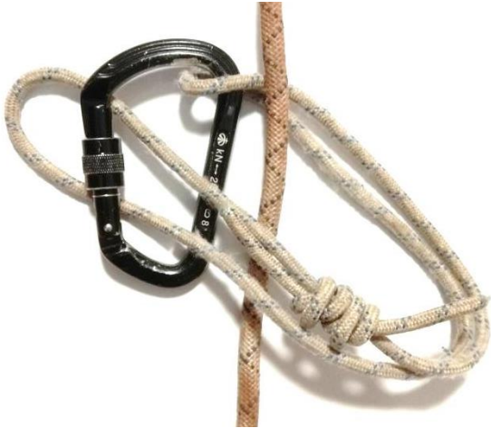
Рис. 3. Більшою частиною тоншої мотузки, пропускаємо через карабін, цим, починаємо робити оберт навколо товщої мотузки і карабіна, одночасно.
