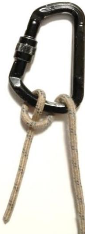
Рис. 7. Використовується як гальмівний пристрій для страхівки або спуску по вертикальних перилах (спуску потерпілого).
