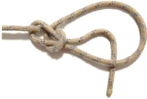
Рис. 11. Початок зав'язування контрольного вузла. Контрольний вузол в'яжеться навколо петлі. Згинаємо ходовий кінець мотузки і проводимо його під петлею.
