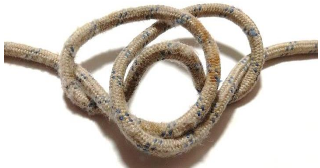
Рис. 8. Пропущену під перехрестям, частину верхнього кільця, видавлюємо ввєрх через нижнє кільце вісімки.
