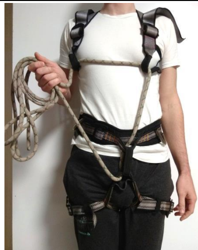
Рис. 4. Розподіляємо довжину кінців мотузки, приблизно порівно (в залежності від того, які кінці Вам потрібно).
