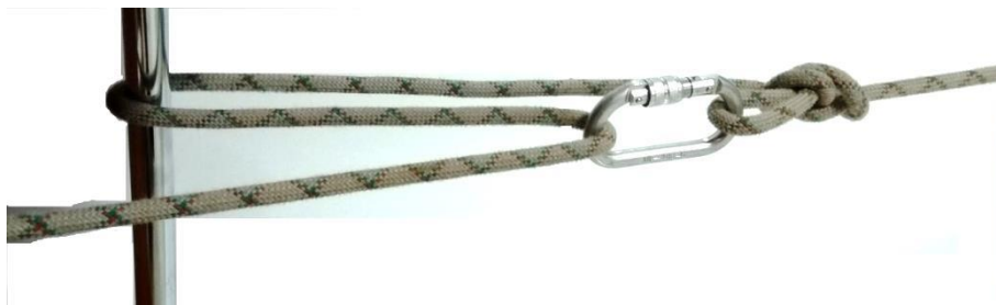
Рис. 2. Огинаємо мотузку навколо опори і прикріплюємо до карабіну (закручуємо муфту), утворюючи поліспаст 3:1.
