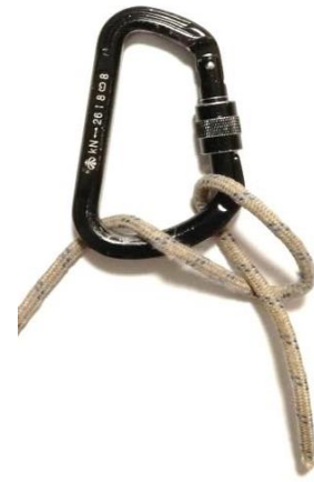
Рис. 6. Сформоване кільце приєднуємо до карабіна і затягуємо вузол, тягнучи за обидва кінці мотузки. Муфту закручуємо.
