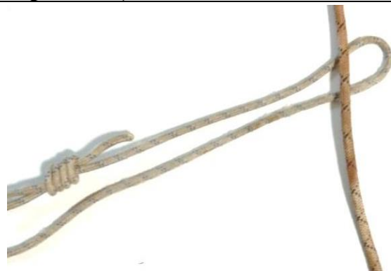
Рис. 2. Складаємо тоншу мотузку в двоє і місце перегину прикладаємо під товщу, роблячи невелику петлю. Якщо тонша мотузка закріплена, то з'єднувальний вузол повинен знаходитись поблизу іншого перегину складеної петлі.
