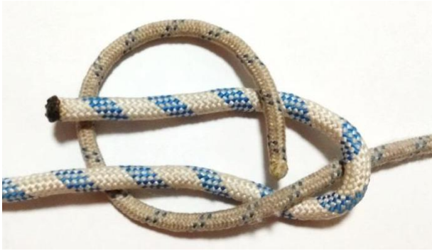
Рис. 5. Ходовий кінець тонкої мотузки накладаємо на обидва кінці товстої мотузки, формуючи один оберт тонкої мотузки навколо обох кінців товстої мотузки.
