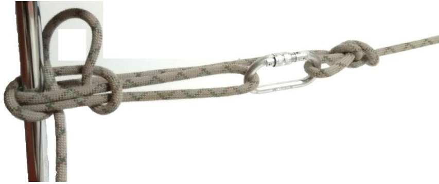
Рис. 4. Блокуємо мотузку за допомогою вузла «штик». Якщо мотузки залишилося достатньо багато, то штик формуємо подвійною мотузкою.
