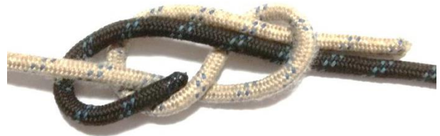
Рис. 8. Продовжуємо рухати ходовий кінець темної мотузки, вздовж світлої, завершуючи формування другого кільця вісімки.
