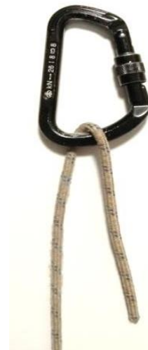
Рис. 3. Опускаємо ходовий кінець до низу і повинен знаходитися правіше від корінного.
