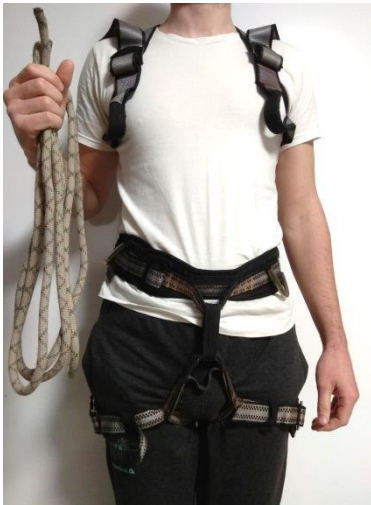
Рис. 1. Одягаємо нижню і верхню системи. Затягуємо і блокуємо пряжки обох систем. Блокування проводимо частиною 10-ти мм мотузки.
