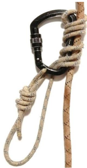
Рис. 8. Завершуємо формування третього оберту. Залишена частина тоншої мотузки направляєється до низу (напряв навантаження вузла). Повинно бути не менше 3-х обертів петлею допоміжної мотузки навколо основної і карабіна.
