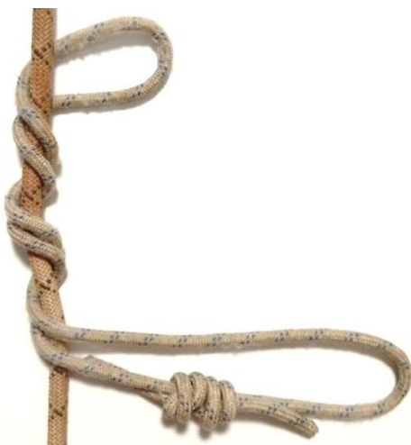
Рис. 7. Завершуємо формувати третій оберт тоншу мотузку навколо товщії.
