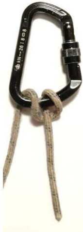
Рис. 7. Використовується як гальмівний пристрій для страхівки або спуску по вертикальних перилах (спуску потерпілого).
