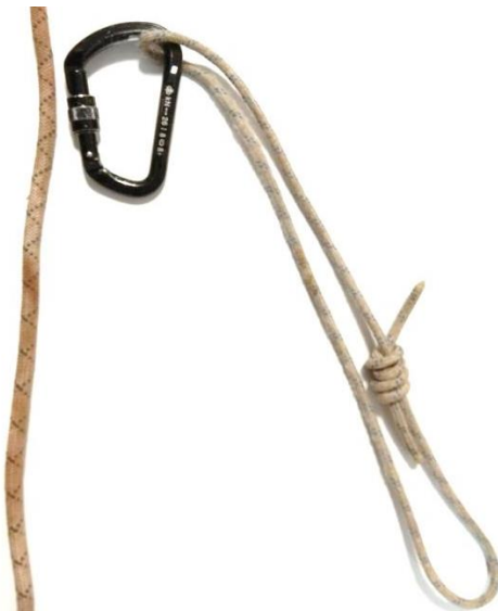
Рис. 1. Вузол в'яжеться тоншою мотузкою навколо товщої і карабіна
