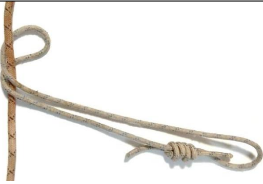
Рис. 3. Більшою частиною тоншої мотузки, робимо оберт навколо товщії. Оберти накладаємо в ту сторону, в яку будемо навантажувати вузол.
