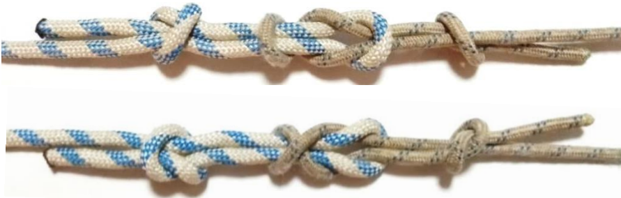
Рис. 19. Вузол повинен бути симетричний, ходові кінці виходять з однієї сторони вузла. Корінний кінець тонкої мотузки повинен перетискати ходовий кінець в місці їх перехрещення. Може застосовуватись для зв'язування мотузок однакового діаметру.
