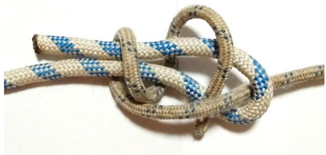
Рис. 10. Ходовий кінець тонкої мотузки пропускаємо вдруге між, обома кінцями товстої і корінним кінцем тонкої мотузки.
