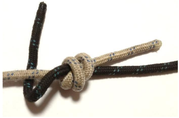
Рис. 10. Ходовий кінець темної мотузки тепер пропускаємо знизу світлої мотузки, формуючи оберт навколо світлої мотузки.
