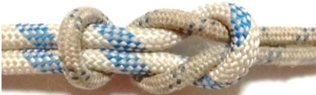
Рис. 11. Беремо обидва кінці товстої та тонкої мотузок і затягуємо вузол.
