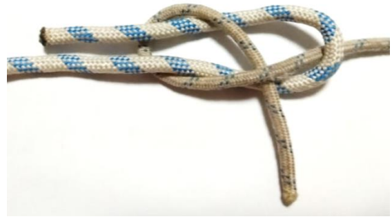
Рис. 6. Ходовий кінець тонкої мотузки пропускаємо між, обома кінцями товстої і корінним кінцем тонкої мотузки. Ходовий кінець тонкої мотузки повинен розміщуватись перпендикулярно по відношенню до інших кінців мотузок.
