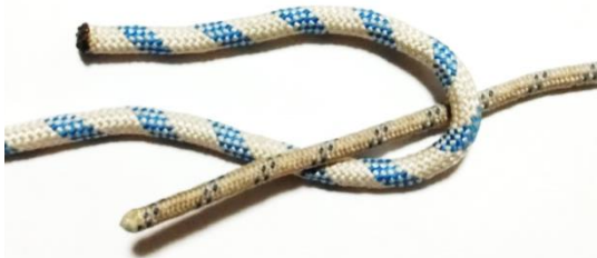
Рис. 3. В сформований перегин, з товщої мотузки, знизу пропускаємо ходовий кінець тонкої мотузки і кладемо його на корінний кінець товщої мотузки.
