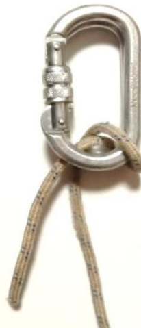
Рис. 7. Застосовується для страхівки або для створення додаткового гальмівного зусилля при натягуванні перил. Карабіни повинні мати однакову форму і розміщуватись в одну сторону.
