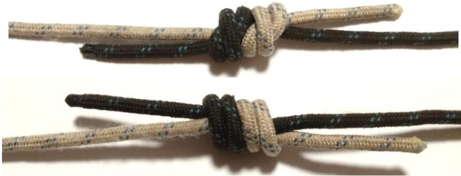
Рис. 16. Вузол повинен бути симетричний, обидві половинки повинні розташовуватись в одному напрямі. Ненавантажені кінці виходять з вузла в діагональній протилежності. Перехрещення мотузок повинні знаходитись з однієї сторони.
