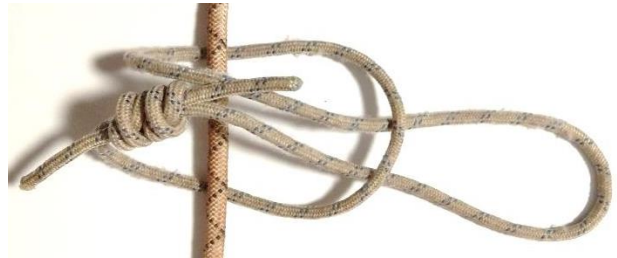
Рис. 4. Просовуємо більшу частину тоншої мотузки в створену раніше петлю.
