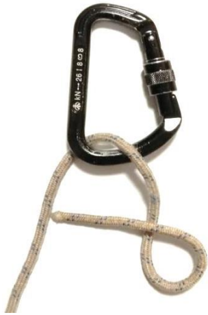
Рис. 4. Вигинаємо ходовий кінець, проти годинникової стрілки, формуючи невелике кільце.
