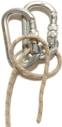
Рис. 5. Прикладаємо сформоване кільце, до муфти лише лівого карабіну.
