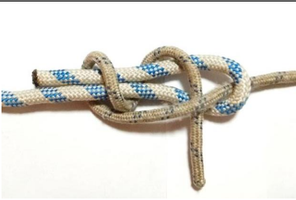
Рис. 11. Ходовий кінець тонкої мотузки повинен розміщуватись в перпендикулярному, по відношенню до інших кінців мотузок, напрямку.
