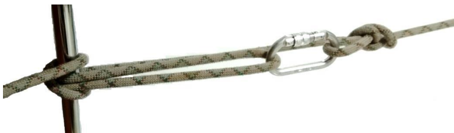
Рис. 3. Натягуємо мотузку і робимо декілька обертів навколо опори. Щоб
