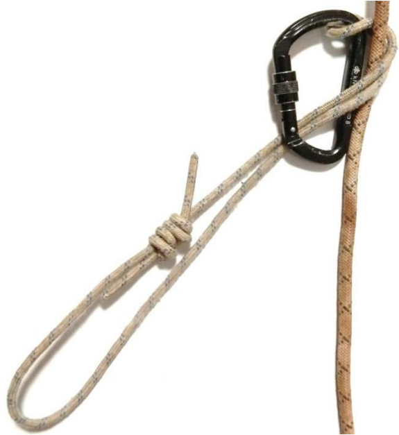
Рис. 4. Більшу частину тоншої мотузки виводимо з карабіну, чим завершуємо формування першого оберту.
