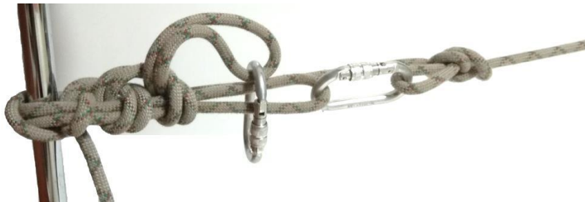
Рис. 5. Вигляд заблокованої мотузки. Контрольним вузлом виступає карабін, який з'єднує кінець від вузла «штик» і саме перило.
