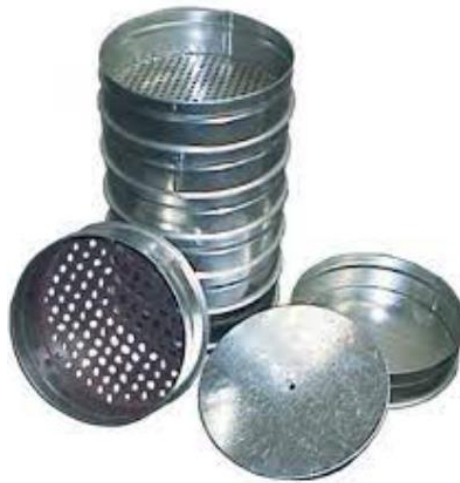
Рисунок 2.3. Обладання (стандартний набір сит) для визначення гранулометричного складу донних осадків
