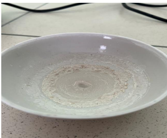
Рисунок 2.4. Визначення загального солевмісту
