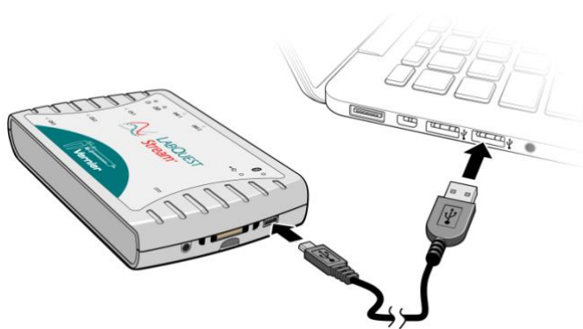
Рис. 1. 5. Підключення LabQuest до порту USB на комп'ютері
