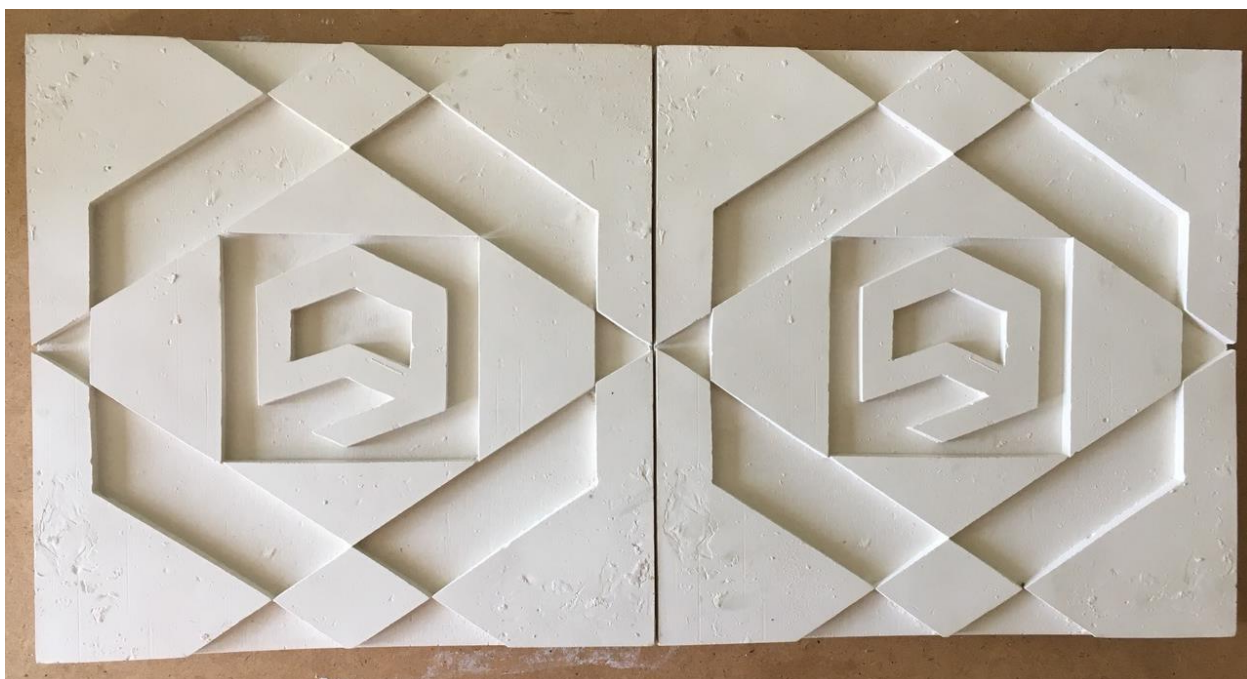
Рис.12(Готова плитка з гіпсу)
