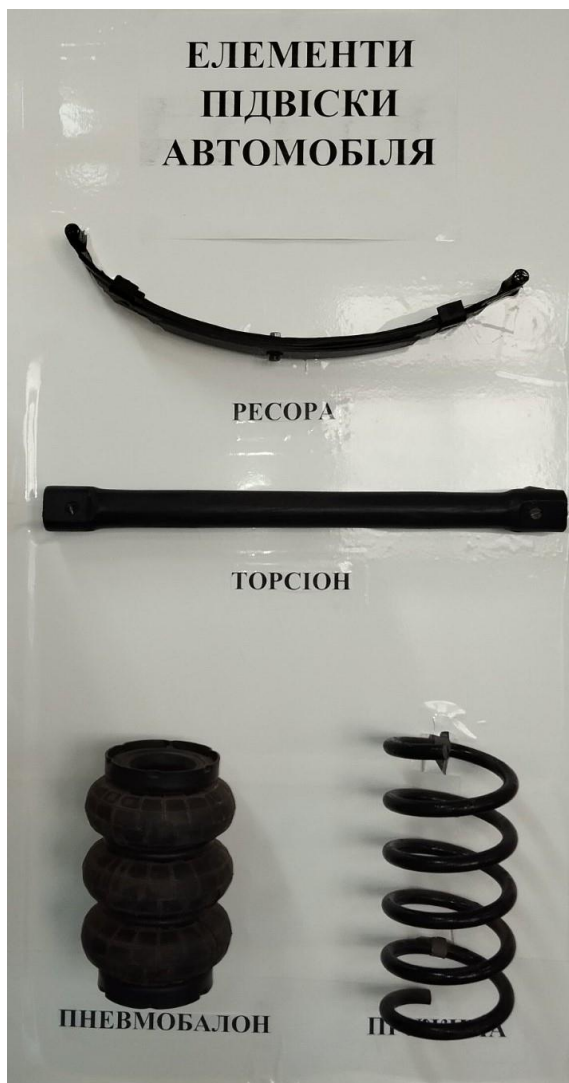
Рис. 3.10. Загальний вигляд елементів підвіски
