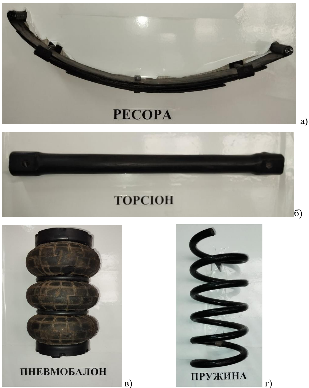
Рис. 3.9 Деталі стенду: а) ресора; б) торсіон; в) пневмобалон; г) пружина
