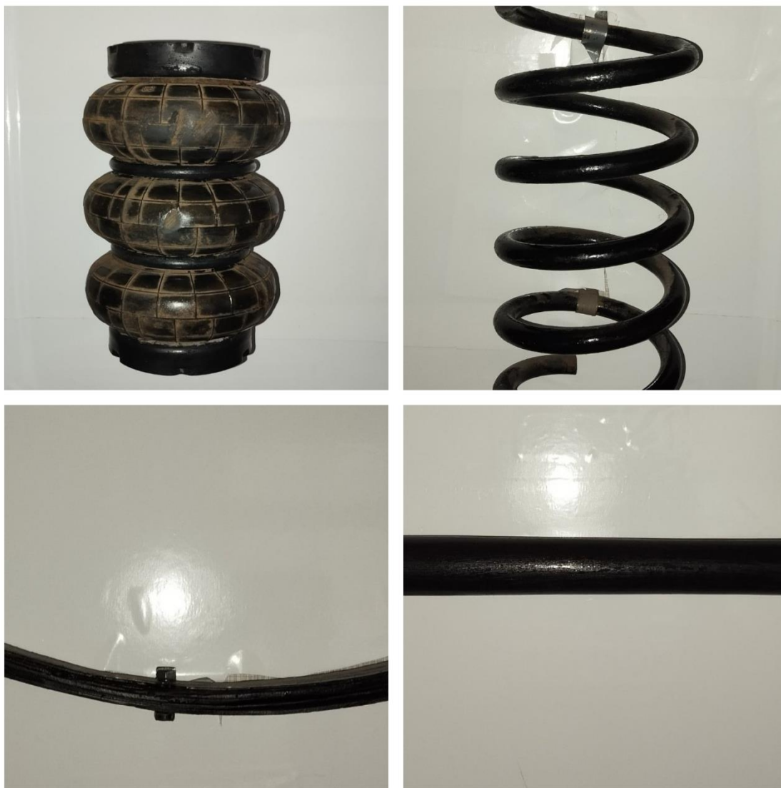
Рис. 4.1. Основні елементи підвіски автомобіля
