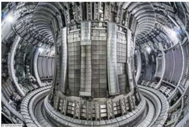
Рис. 5.25. Об'єднаний європейський тор (JET). Термоядерний детектор на токамаку використовує магнітні поля для злиття ядер дейтерію та тритію
