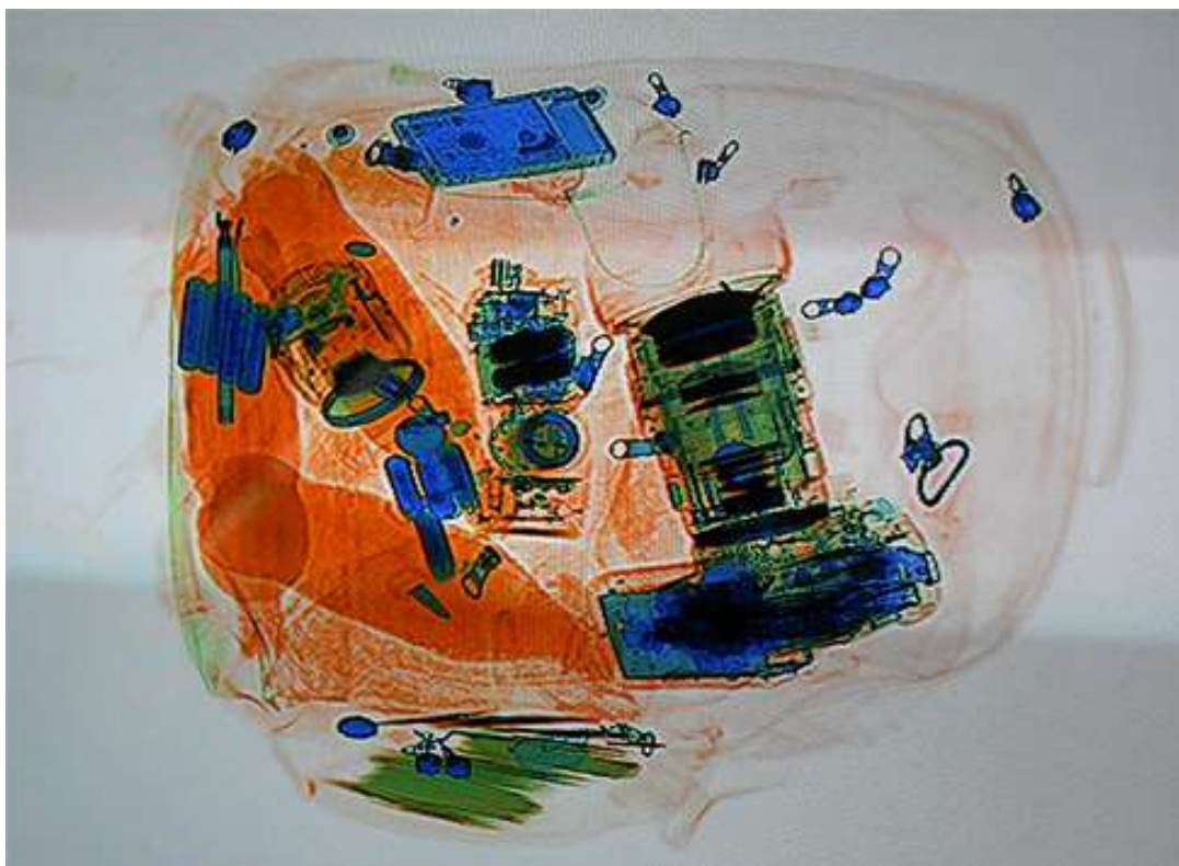
Рис. 3.26. Рентгенівський знімок місця багажу. Чим щільніше матеріал, тим темніше тінь. Кольори об'єктів пов'язані зі складом матеріалу — металеві об'єкти на цьому зображенні відображаються синіми
