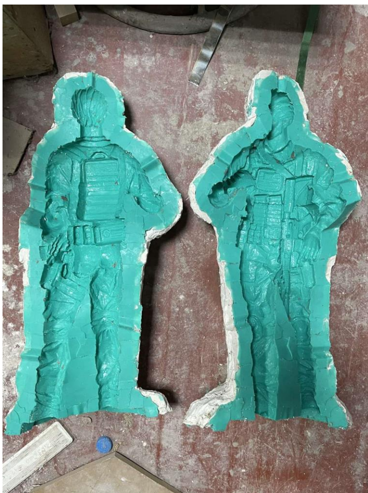
Рис.2.11. Зняття затверділого силікону зі скульптури.
