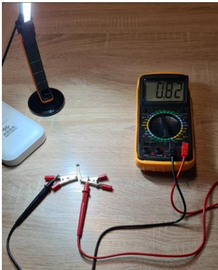
Рис. 1.4. Зміна опору фоторезистора при зміні освітлення
