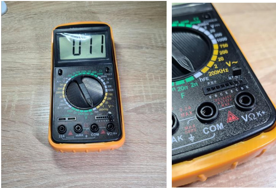
Рис. 1.7. Вимірювання коефіцієнта підсилення транзистора.
