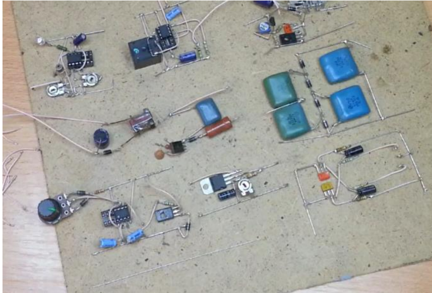
Рис. 2.3. Приклад збирання схеми методом навісного монтажу
