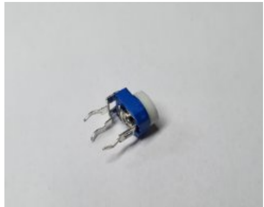
Рис. 3.6. Резистор R1 = 50кОм (змінного опору)
