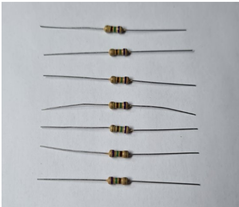
Рис. 3.8. Резистори R_3 - R_9 = 750\text{Ом} - 1\text{кОм} .
