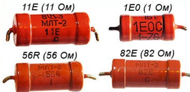
Рис. 1.8. Маркування резистора буквами та цифрами.
