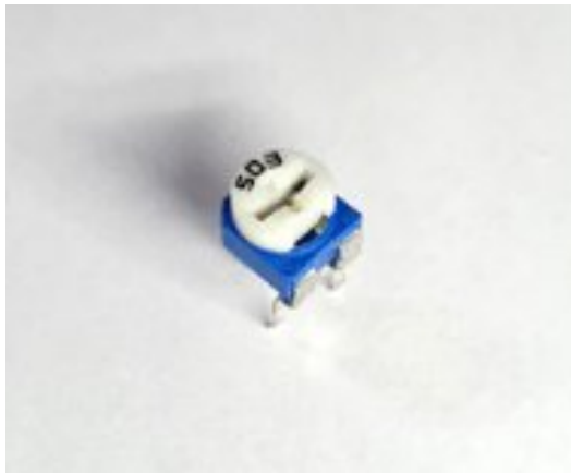
Рис. 3.6. Резистор R1 = 50кОм (змінного опору)
