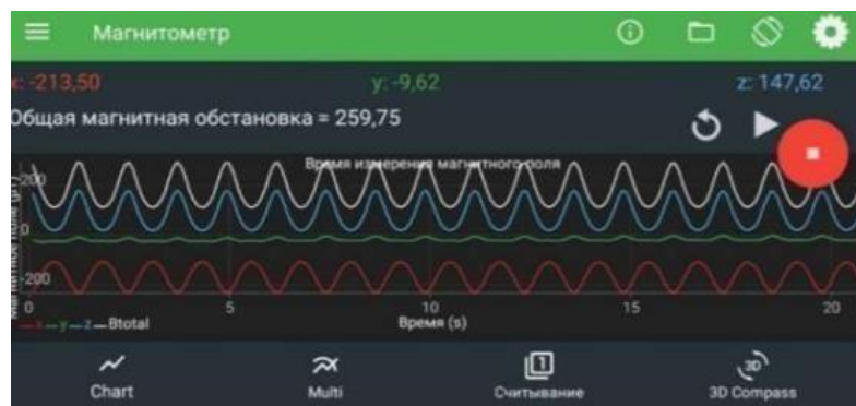
Рис. 3.5. а) Фото дослідницької установки; б) Вигляд дисплея під час коливання математичного маятника (застосунок “Магнітометр” Phyphox та застосунок “Магнітометр” Physics Toolbox Sensor Suite)
