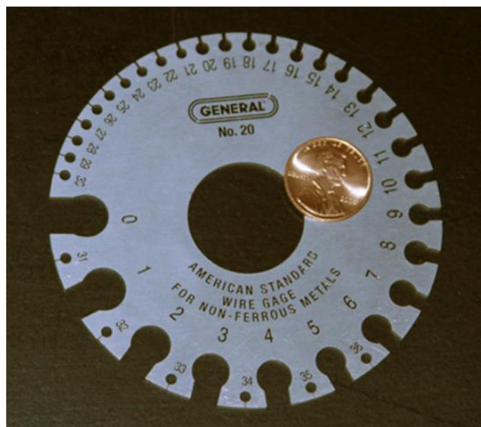
Рис. 5.11. Прилад для вимірювання діаметру електричного дроту. Як бачите, більші значення калібру вказують на більш тонкі дроти
