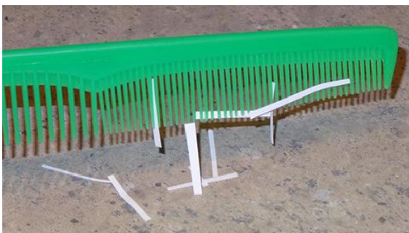
Рис. 1.3. Після розчісування волосся цей гребінець здалеку притягує маленькі смужки паперу без фізичного контакту. Дослідження цієї поведінки смужок паперу допомогло створити концепцію електричної сили
