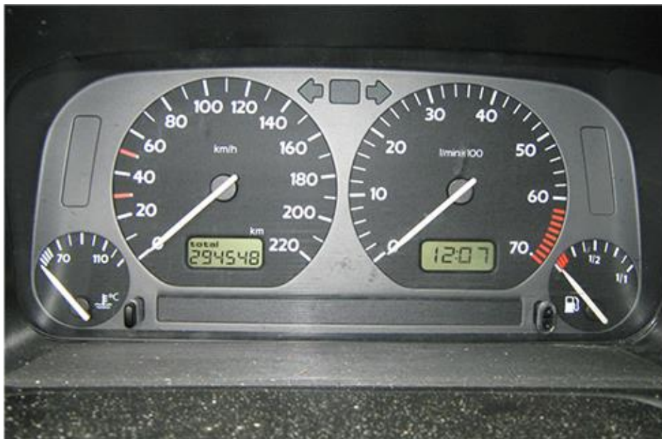
Рис. 6.34. Показчики палива і температури (крайній правий і крайній лівий відповідно)– це вольтметри, які реєструють вихідну напругу «відправних» блоків. Ці одиниці пропорційні кількості бензину в баку і температурі двигуна
