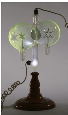
Фото 6. Пулюева катодна трубка із подвійною тінню
