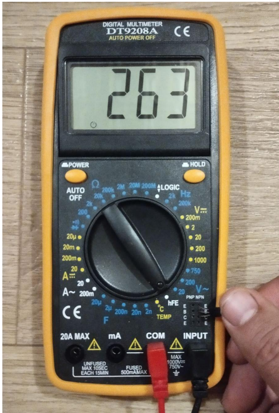
Рис. 4.9. Визначення коефіцієнту підсилення n-p-n транзистора за допомогою мультиметру
