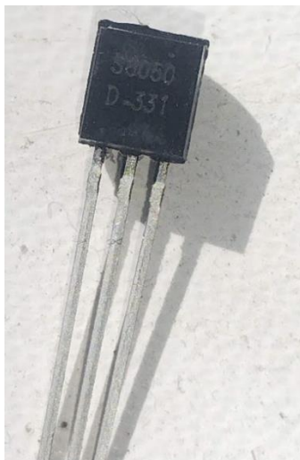
Рис. 2.18. Біполярний транзистор NPN SS8050
