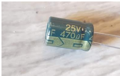
Рис. 2.14. Конденсатор 470мкФ, 25В
