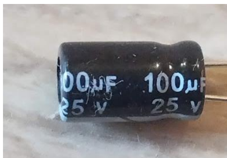
Рис. 2.16. Конденсатор електролітичний 100мкФ, 25В
