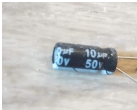
Рис. 2.17. Конденсатор електролітичний 10мкФ, 50В
