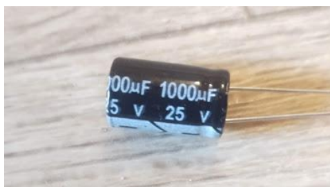
Рис. 2.15. Конденсатор електролітичний 1000мкФ, 25В
