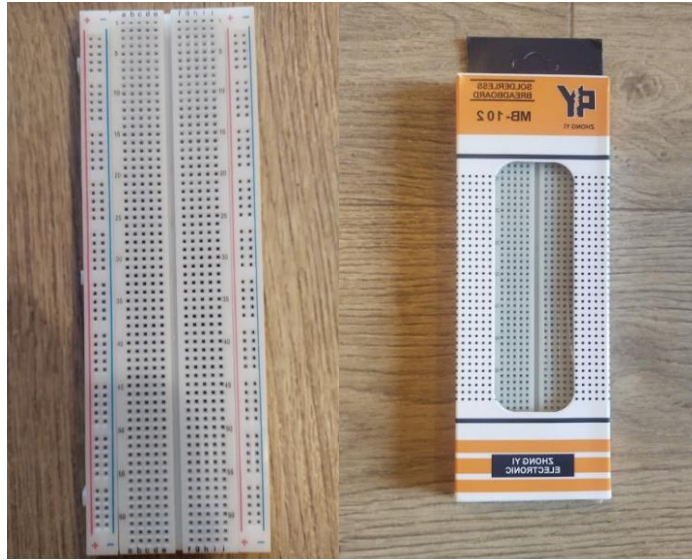
Рис. 2.28. Монтажна плата Breadboard MB-102 830 pin 165x55мм.
