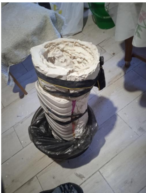
Рис.42. Установка опоры для подальшої заливки гіпсом
