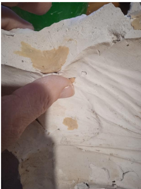
Рис..40 Зачистка негативу, шліфування, підготовка до лиття
