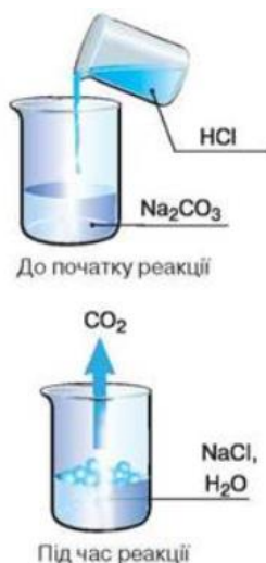
Рис.1.4. Реакція обміну між карбонатом і кислотою [6]
