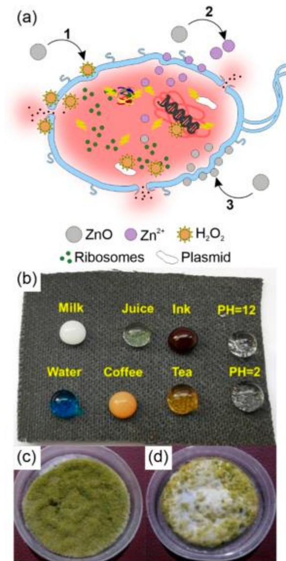
Рис. 11. (а) Схема антимікробного механізму дії ZnO проти бактеріальної клітини: (1) утворення активних форм кисню, (2) розчинення ZnO на Zn 2+ , (3) пряма взаємодія між ZnO і клітинною мембраною. Адаптовано з посилання 76 (Creative Commons CC BY). (b) Зображення цифровою камерою різних рідин на тканині з нанокompозитним покриттям на основі нанодроти ZnO. Передруковано з дозволу з посилання 47. Copyright 2020 American Chemical Society. Зростання грибка на тісті через 5 днів: (c) чисте тісто, (d) тісто, покрите 20% C-легованим ZnO
