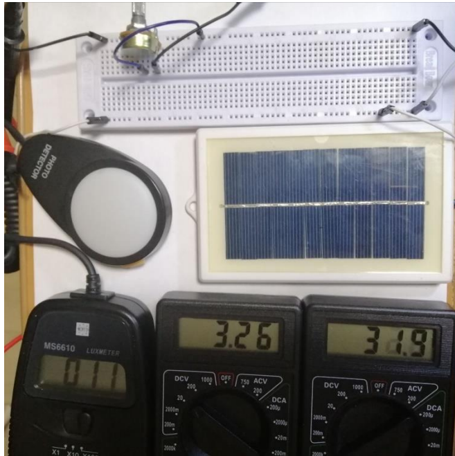
Рис. 4. Експериментальна установка для визначення вольт-амперної та люкс-вольтної характеристики фотоелементу
