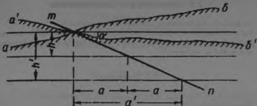
Рис. 7.4. Залежність між величиною закладення a та a' і відстанню між горизонтальними площинами h і h'' , які січуть верству ( m ): ab та a'b' – різні варіанти форми рельєфу
