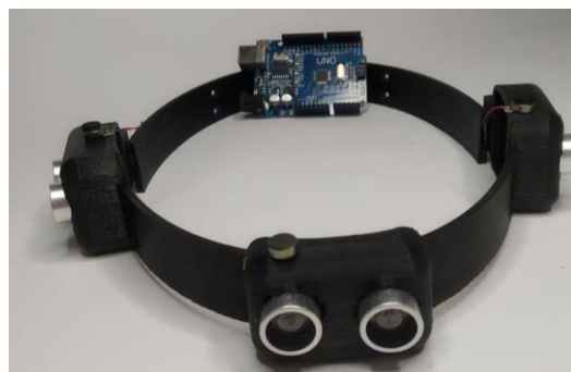
а) прототип б) кінцевий результат Рис.1. Смарт-пристрій для людей з особливими потребами
