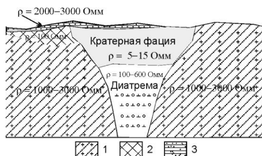
Рис.1. Схематическая геоэлектрическая модель кимберлитовых трубок в провинции Кванза-Сул. 1 – вмещающие породы: гнейсы, кристаллические сланцы и кварциты (Ar-Pr1), 2 – коры выветривания по породам фундамента (Pr1), 3 – породы группы Калахари: песчаники, глины и конгломераты (P-N).
