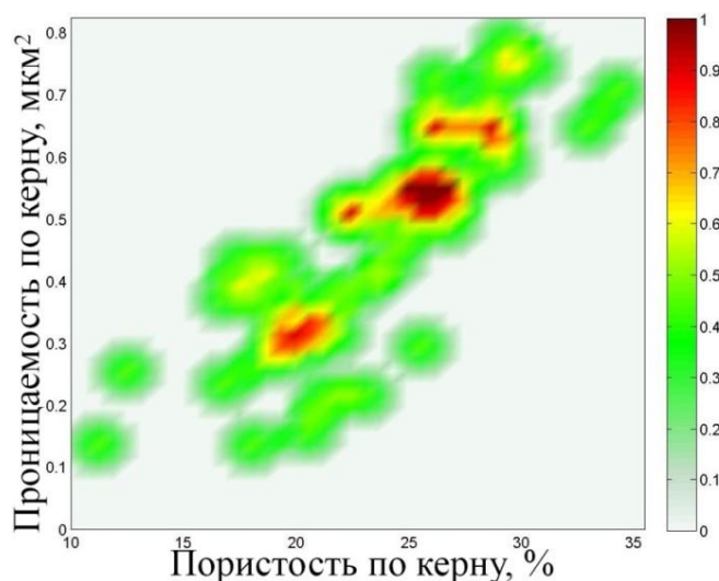
Рис. 2. Нечеткая петрофизическая модель отношения между параметрами «пористость по керну» и «проницаемость по керну», построенная на базе модели конуса
