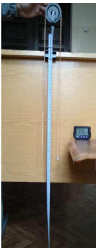
Рис.3.1. Експериментальна установка, щодо дослідження падіння ланцюга з довільної висоти h
