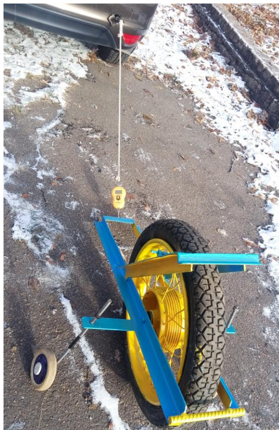
Рис. 2.9. Дослідження параметрів колеса автомобіля за допомогою динамометричного возика
