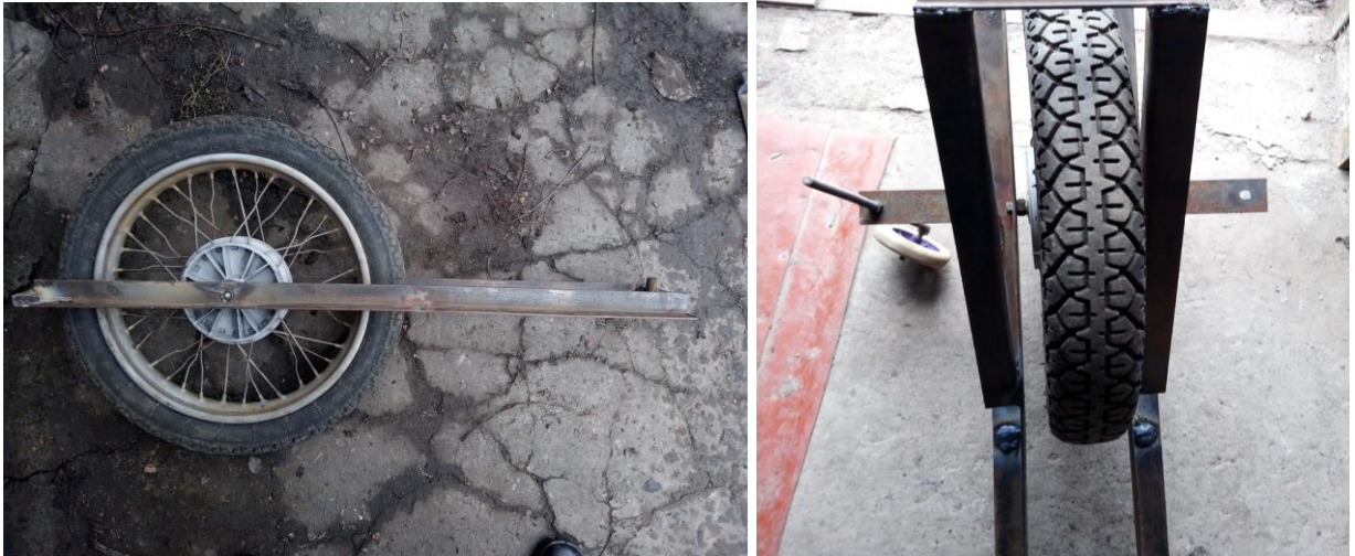
Рис. 2.7. Установка головного колеса на станині і допоміжних коліс
