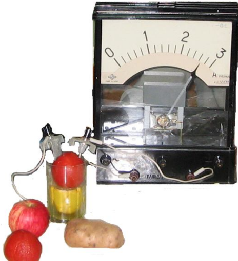
Рис. 8. Дослідження провідності фруктів і овочів
