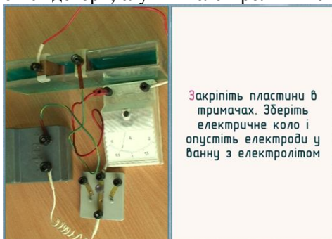
Рис. 3. Дослідження явища електролізу
