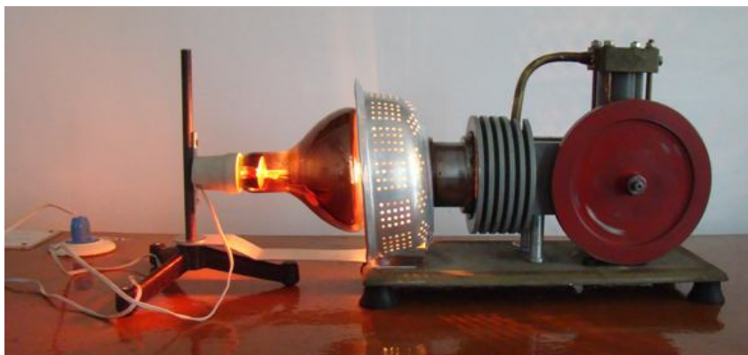
Рис. 7. Двигун Стірлінга працює від світла інфрачервоної лампи потужністю 240 Вт
