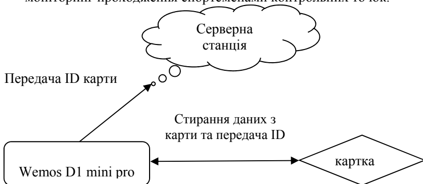
Рис. 1. Схема роботи приладів для реєстрації учасників турніру
