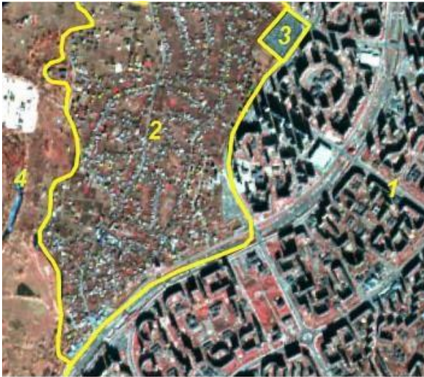
Рис. 3.1. Приклад дешифрування забудови (1 — багатоповерхова міська забудова; 2 — одно-двоповерхова приміська забудова; 3 — гаражі, промзони; 4 — незабудовані луки)
