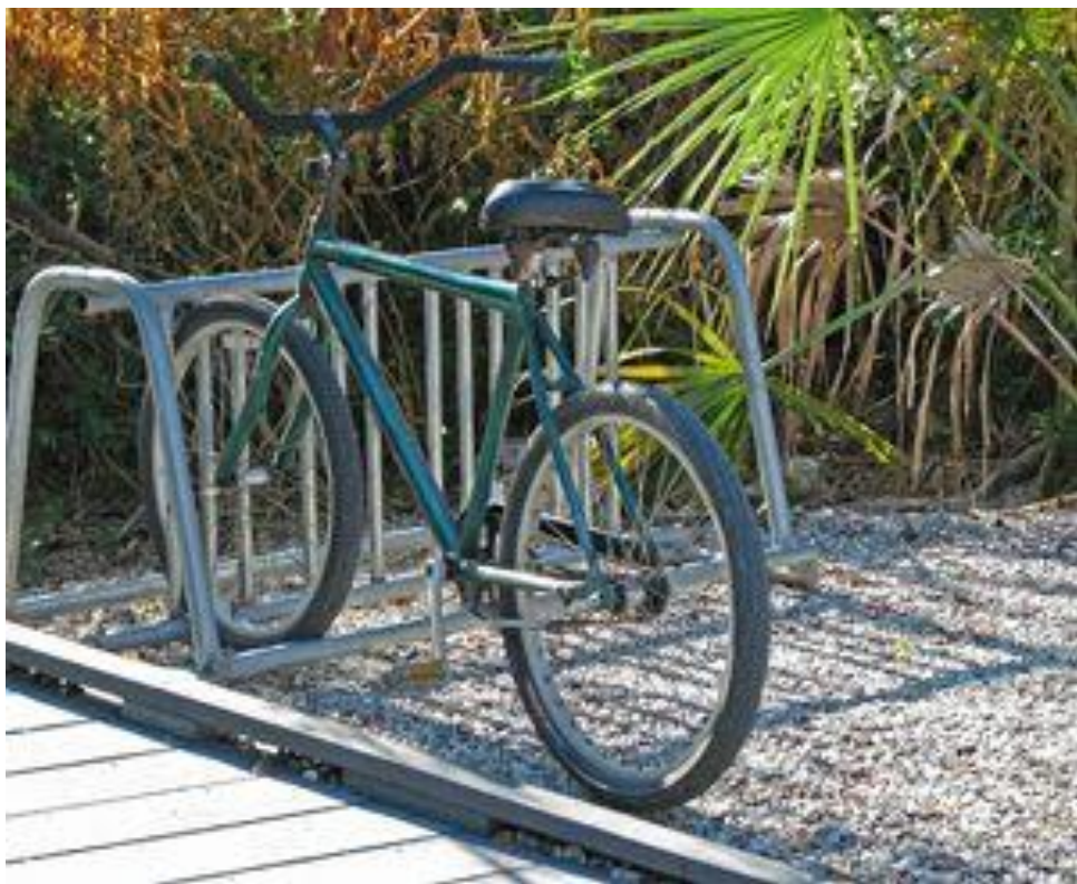
Рис. А.1.2.4. Стенд із кріпленням для одного колеса
