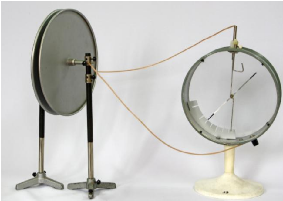
Рис.2.19. Ілюстрація поняття електроємності.
