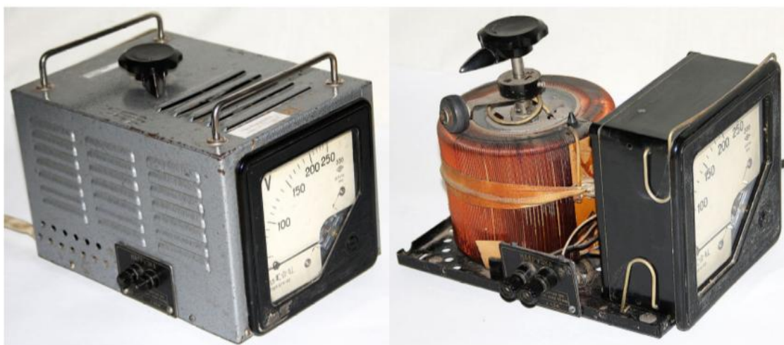
Рис.2.21 Зовнішній та внутрішній вигляд РНШ.
