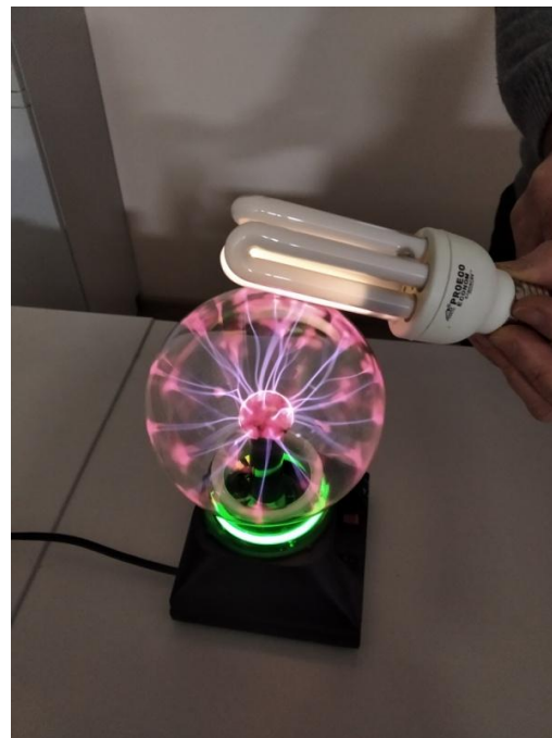
Рис.2.42. Газовий розряд у люмінесцентній лампі.
