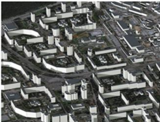
Рис.2.4. Тривимірна модель міста Єкатеринбург, побудована з використанням стереопари з супутника "IKONOS": каркасна модель міської забудови (ліворуч), та високодетальна модель, з опрацюванням кожної споруди і відповідного текстурування тривимірних об'єктів (праворуч)
