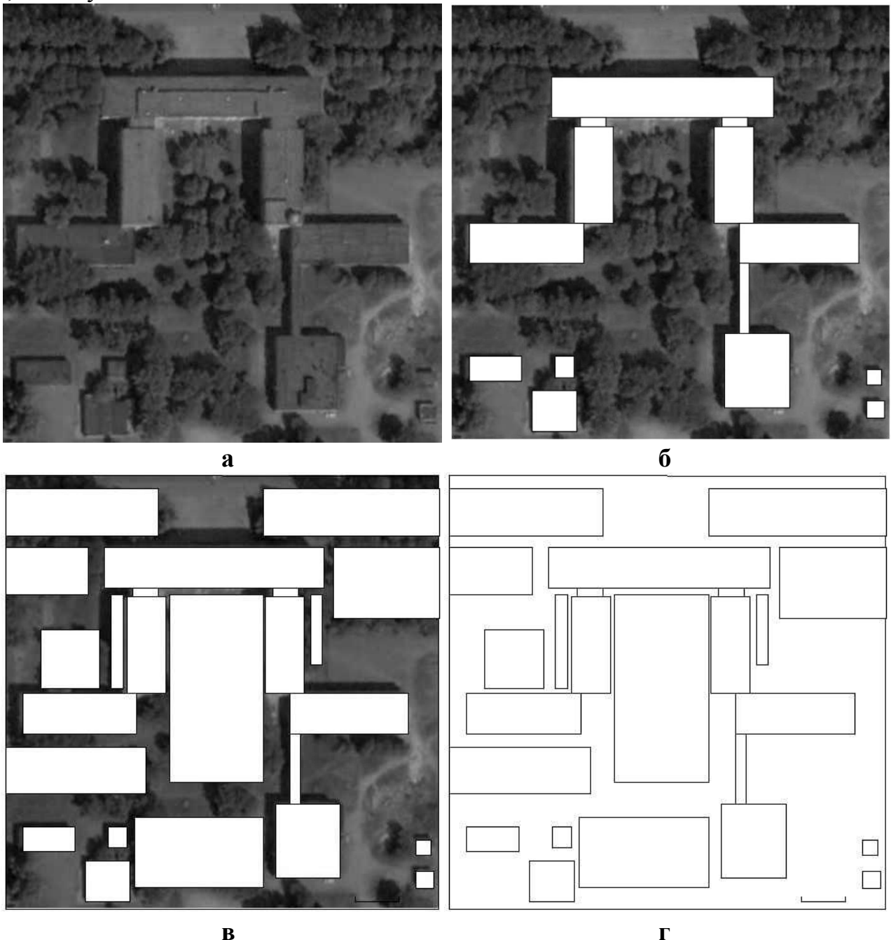
Рис. Д-6. Етапи побудови топографічного плану за даними дешифрування аерокосмічних знімків
