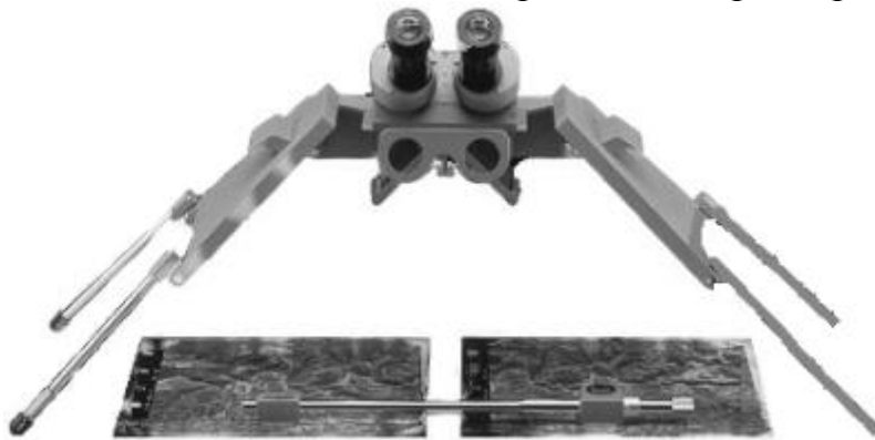
Рис. 1.43. Стереоскоп для дешифрування аерокосмічних знімків
