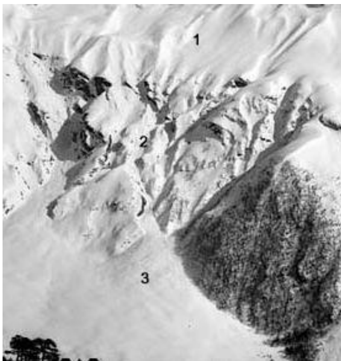
Рис. 2.24. Супутниковий знімок лавинозборів: 1 – лавинні осередки; 2 – зони транзиту; 3 – зона акумуляції
