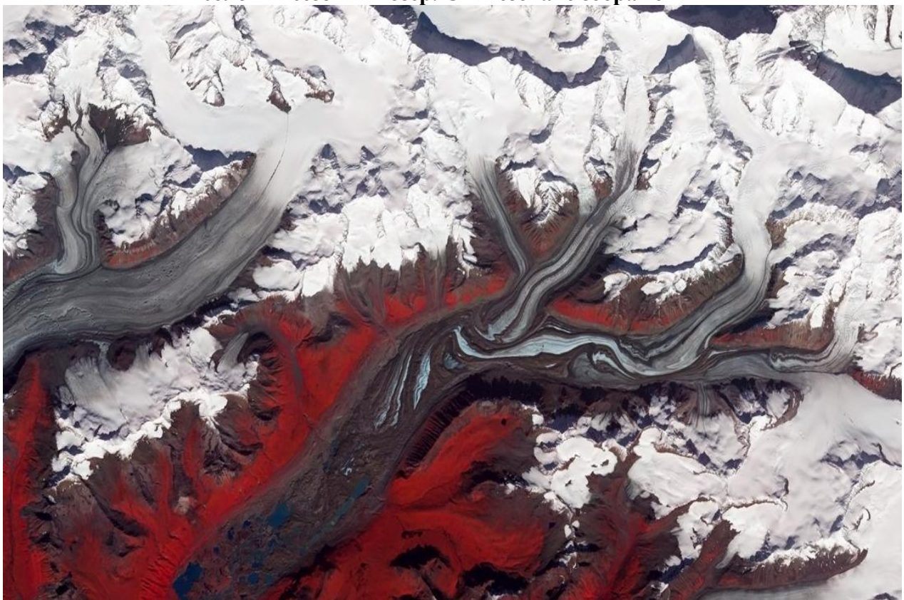
Рис. 1.39. Супутниковий знімок льодовика Сусітна на Алясці поєднує в собі інфрачервоні, червоні і зелені довжини хвиль, утворюючи знімок ненатурального кольору. Кольори на знімку відповідають: червоний – рослинності; блакитний – вільному від бруду льоду; коричневий – брудному льоду.
