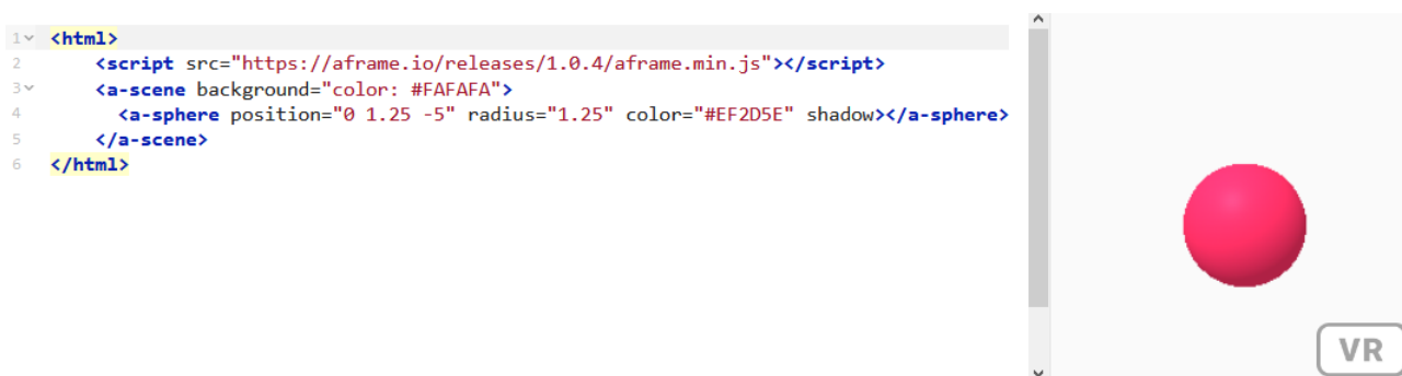
Рис. 1.8. Вихідний код та результат роботи простої програми на A-Frame
