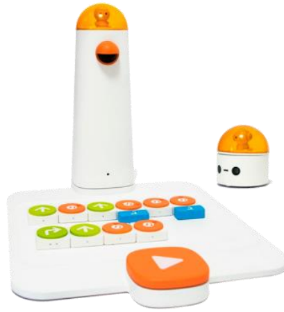
Рис. 1. Робот (Matatabot), керуюча (командна) вежа та панель управління
