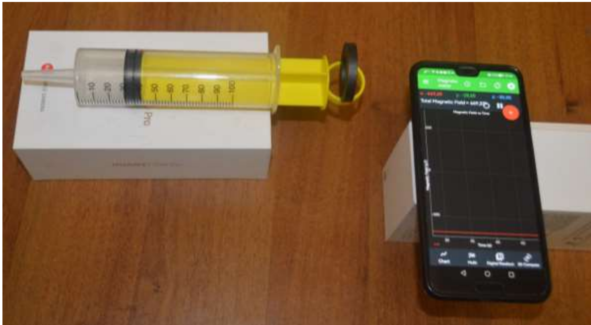
Рис. 5. Фото установки для вимірювання залежності величини магнітної індукції від відстані вздовж осі кільцевого магніту
