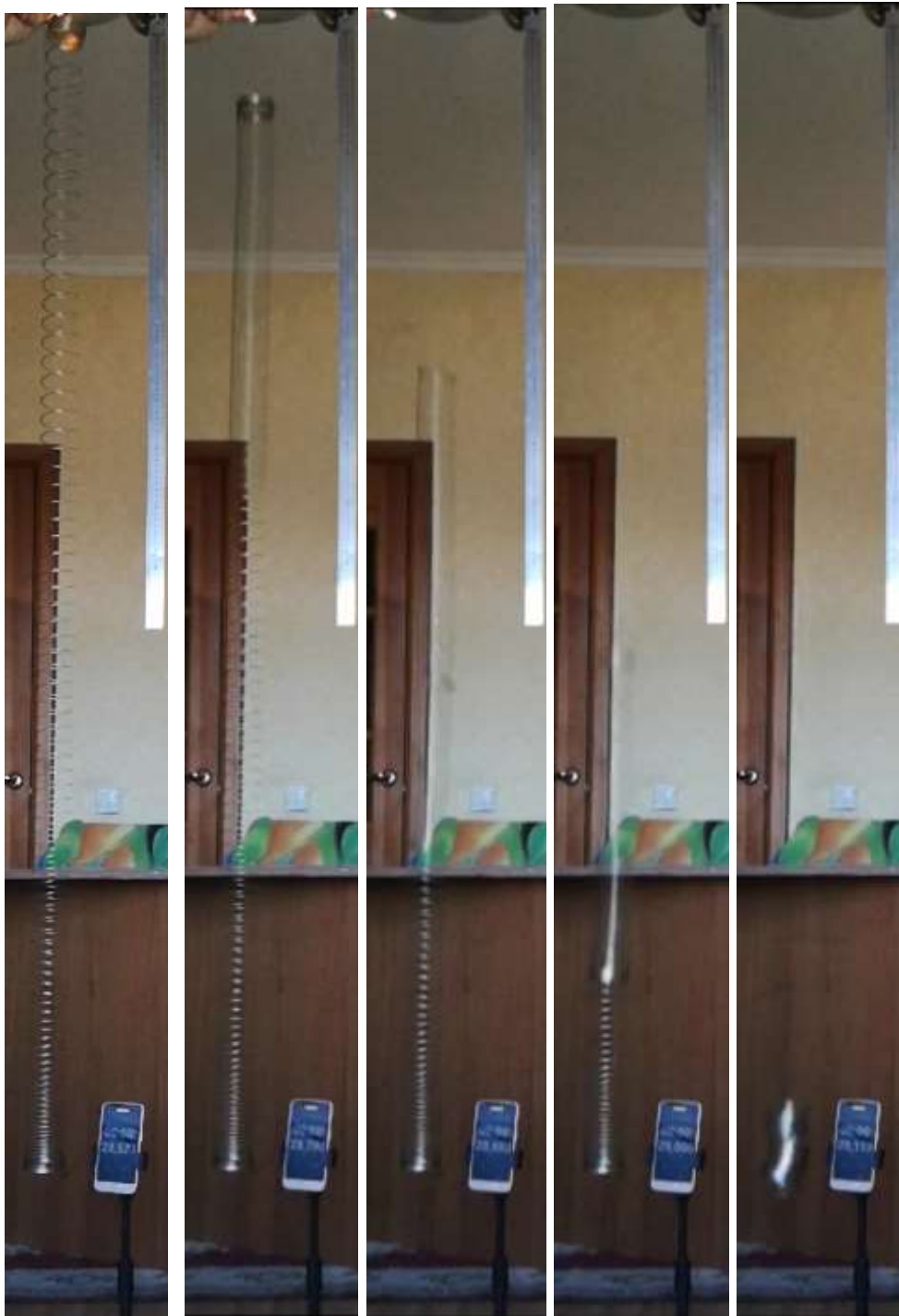
Рис. 3. Фази падіння пружини довжиною 185см діаметром 60 мм. Верхній кінець пружини досягає низу за 29,162 - 28,571 \text{ с} = 0,59 \text{ с}
