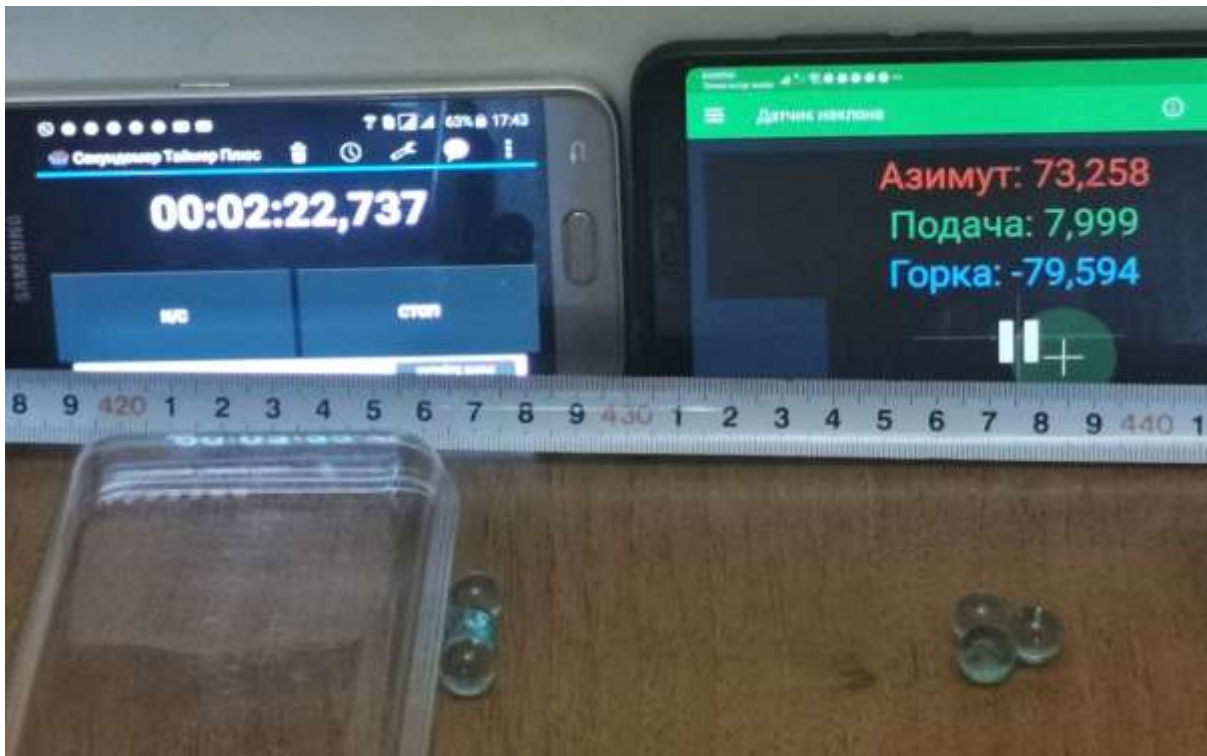
Рис. 3. Обладнання для дослідів: 1 – похила площина (стілниця стола), 2 – тіло, що котиться, 3 – тіло, що має тертя ковзання, 4 – лінійка, 5 – стартова колодка, 6 – смартфон з секундоміром, 7 – смартфон з датчиком нахилу
