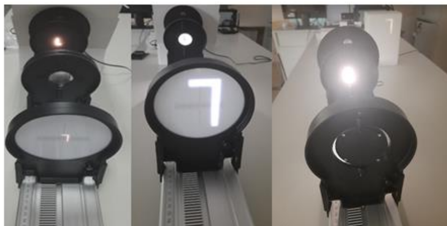
Рис. 3.22. Утворення дійсного зменшеного та збільшеного перевернутого зображення літери L та дійсне зображення у сферичному дзеркалі.
