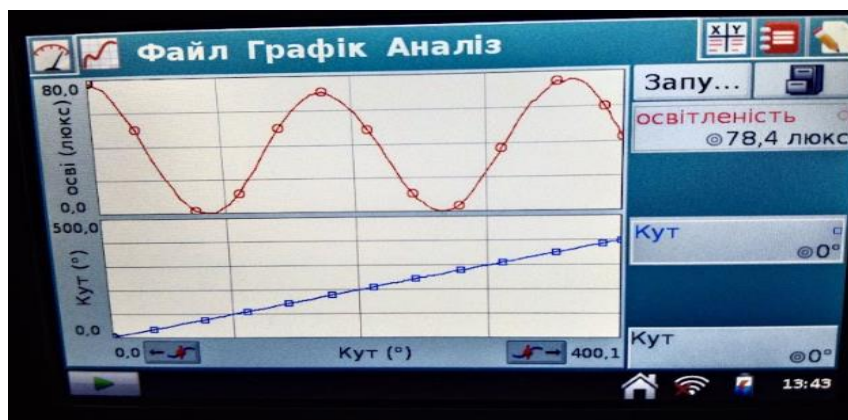
Рис. 3.19. Графік зміни інтенсивності світла, що пройшло через систему поляризатор-аналізатор.
